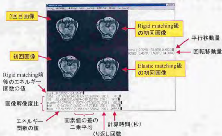
Fig. 2-14 ユーザーインターフェースの例。すべての操作はマウスのみで可能。膝関節ACLを撮影したMRIのマッチング結果。表示断面は冠状、矢状、軸位断面のいずれも選択可能である。
