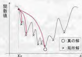
Fig. 2-4 極小点が多数存在する関数における真の解と局所解の関係。 x = x_0 である点から最小点を探索する場合、真の解(○)に到達する以前に多くの局所解(x)が存在するため、それを真の解と誤る可能性がある。
