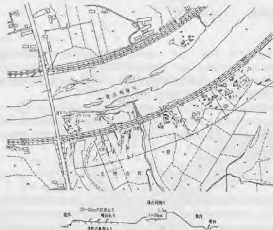
図 1.6: 後志利別川の堤防被災状況の平面・断面図 (西川ら 1993)
