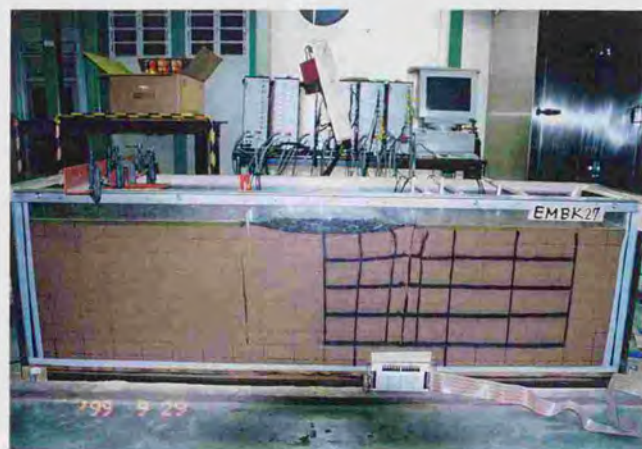
図 C.6: 実験 E27 (排水矢板締切・排水材締切内側) の加振終了後
