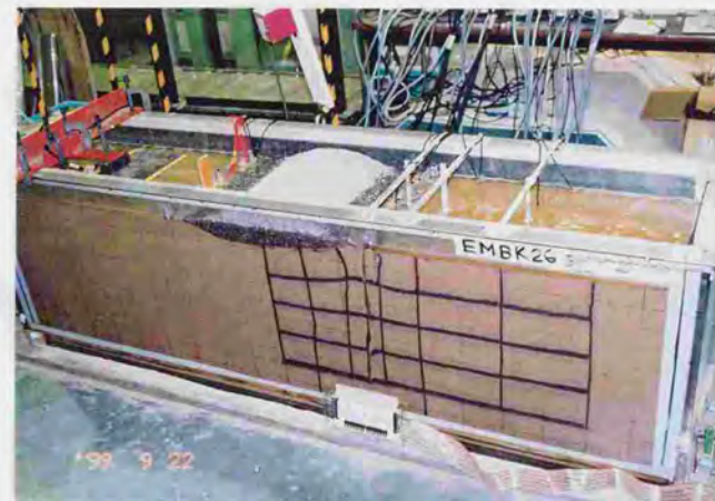
図 C.5: 実験 E26 (排水矢板縮切・排水材縮切外側) の加振終了後
