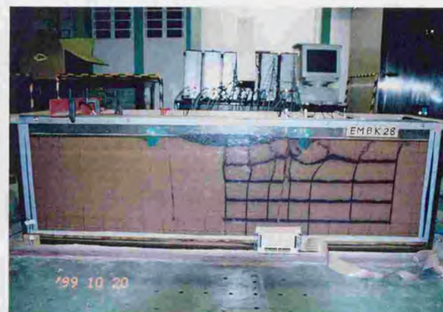
図 C.9: 矢板締切と押え盛土を併用した実験 E28 の加振終了後
