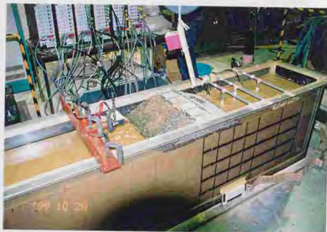
図 C.10: 実験 E30 (法肩矢板縮切) の加振前
