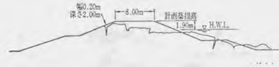
図 1.3: 釧路川遊水池左岸堤防の変状 (西川・高橋 1993)
