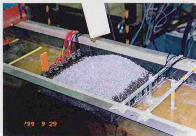
図 C.7: 実験 E27 (排水矢板締切・排水材締切内側) の加振終了後
