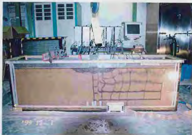
図 C.11: 実験 E30 (法肩矢板縮切) の加振終了後
