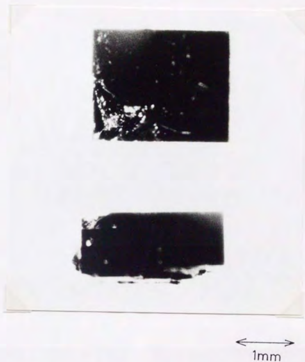
図VI-11. 立方状晶。組成21 with \text{Cu}_2\text{O} の出発物質。 (\text{Y}_{0.15}:\text{BaO}:\text{CuO}:\text{CuO}_{0.5} = 0.05:0.325:0.3125:0.3125) から得られた。上の写真と下の写真は各々同一の 結晶を \text{CuO}_2 面に垂直な方向からと面内方向から 撮影したもの。各々の面はほぼ平らで、各面の間の 稜がほとんど直線になっている。
