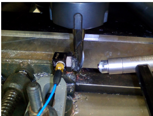
(a) ハンマリングテストによる工具のFRF測定
