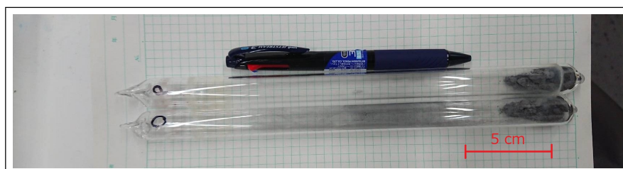
図 3.1 原料を封じた石英ガラス管。
