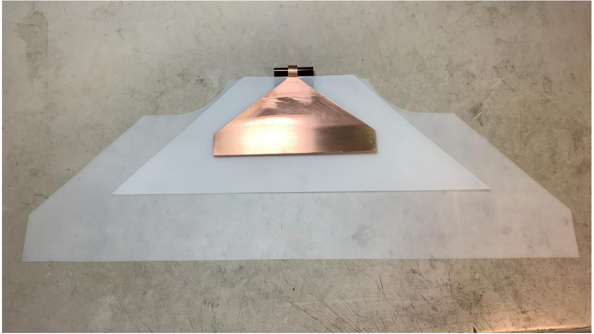
図 3.19 設置前の一巻きコイルの絶縁対策
