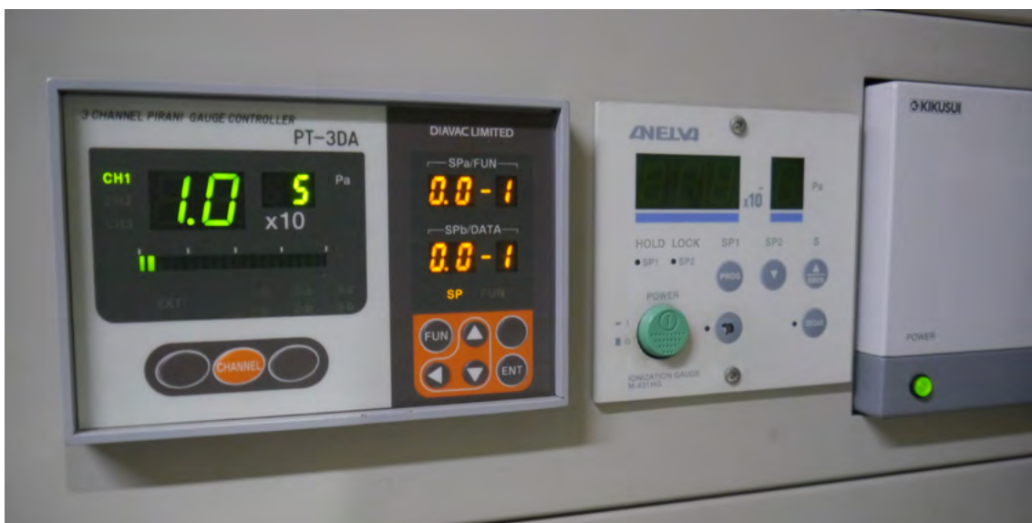
図 2.4. 圧力計モニター。左がピラニ圧力計で右が熱陰極タイプ真空計.
