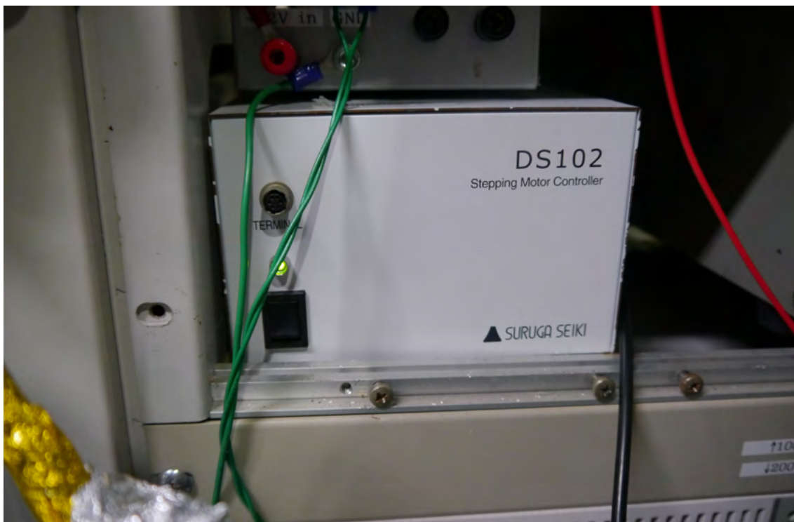
図 2.31. リニアアクチュエータのコントローラー：SURUGA, DS102.
