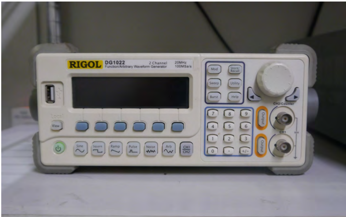
図 2.25. ファンクションジェネレータ : RIGOL, DS-1022.
