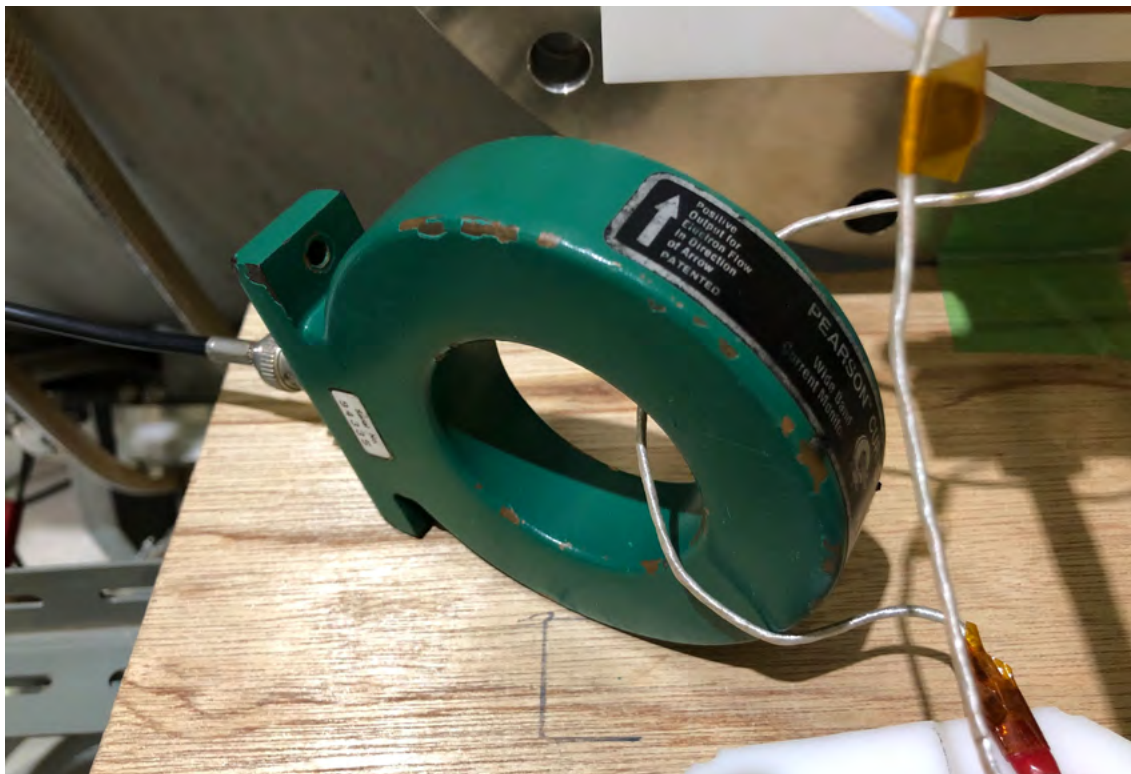
図 2.20. 非接触電流計 (Rogowski Coil) : Pearson, Model101.
