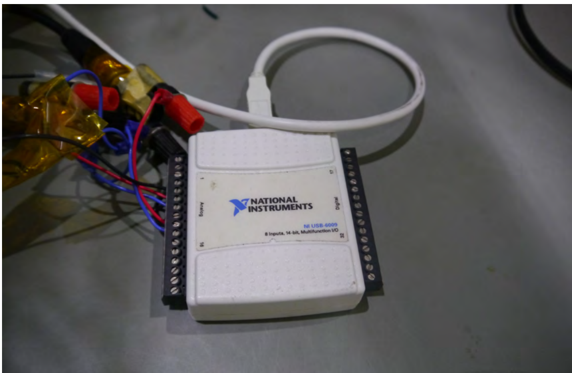
図 2.26. アナログ電圧ロガー : NI-DAQ6009.
