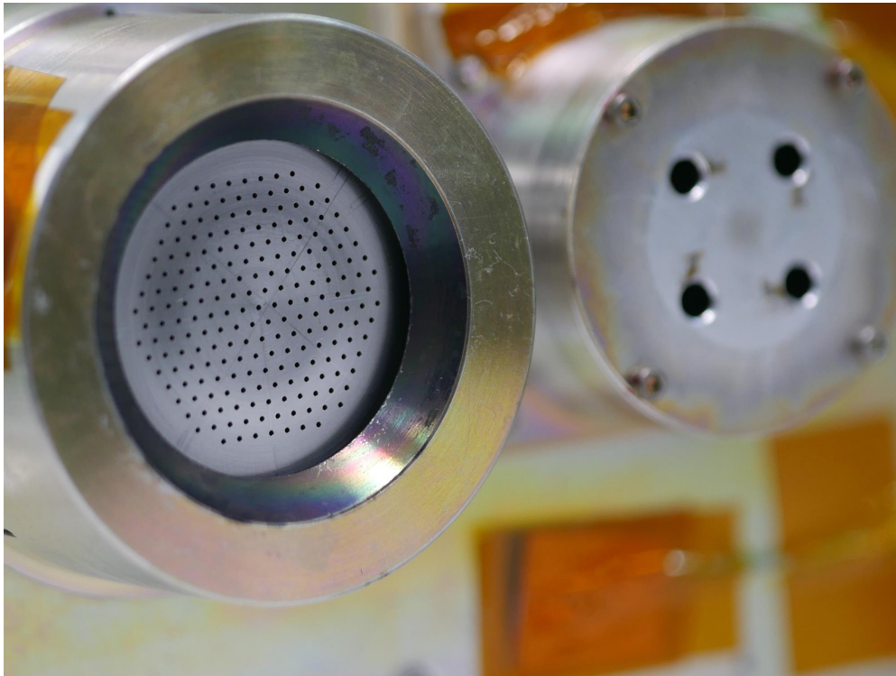
図 32 d0.3t0.15-0.25 の外観。影により微小な凹凸が視認できる。
