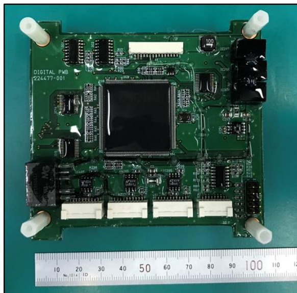
図 26. 試験に供した FPGA 基板 (Actel 社、ProASIC3)
