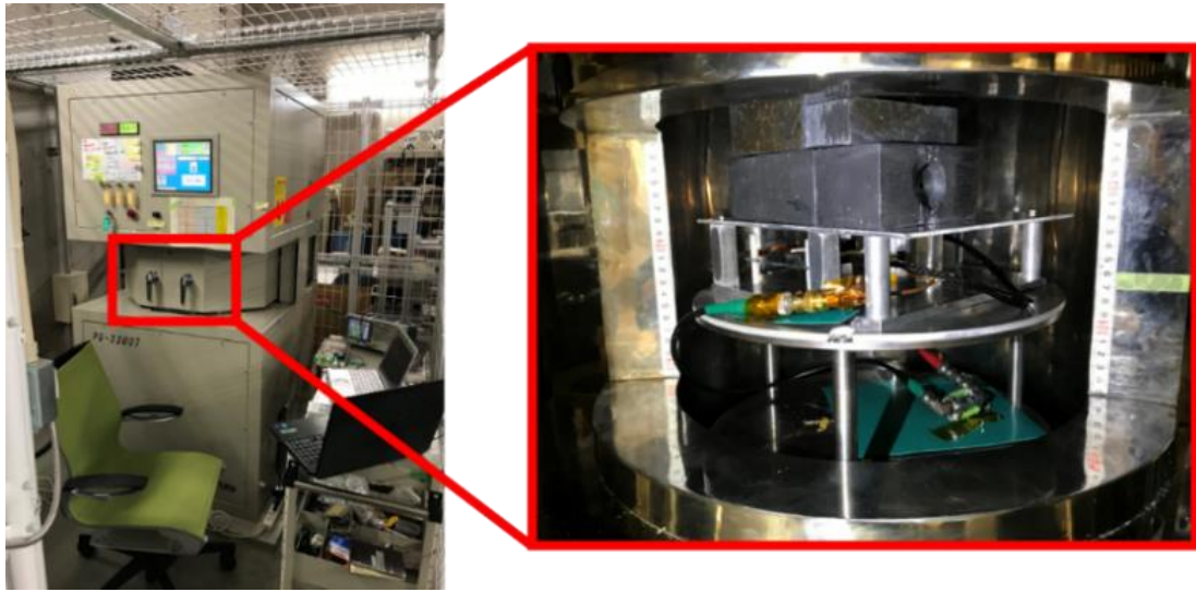
図 20. ガンマ線照射試験の様子 (左) : ガンマ線照射装置 (右) : ガンマ線照射装置内部
