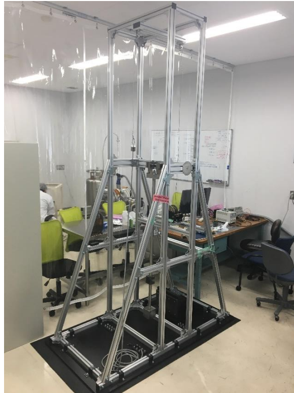
図 2. ハンマー型衝撃試験機（宇宙航空研究開発機構研究開発報告, JAXA-RR-19-005）
