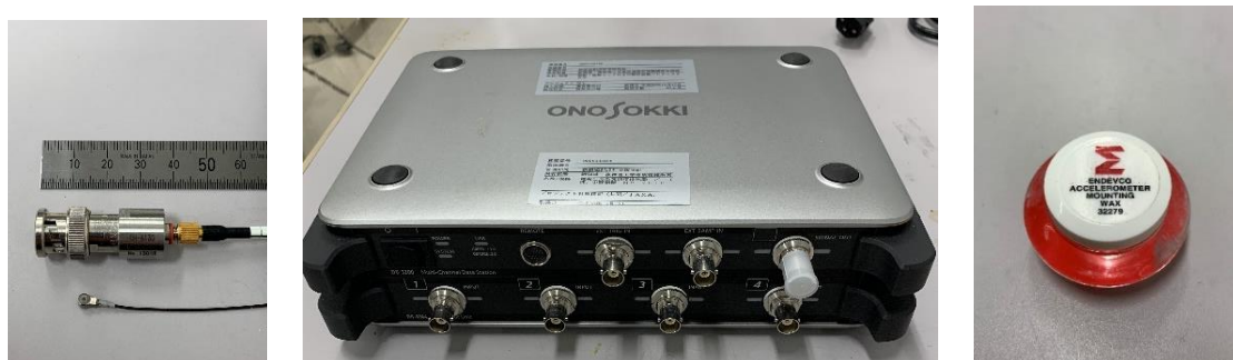
図 4. 加速度センサおよびチャージコンバータ（左）データロガー（中央） 接着剤（右）
