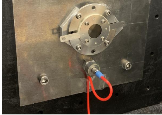
図 34. 加速度センサ周りのケーブル配線
