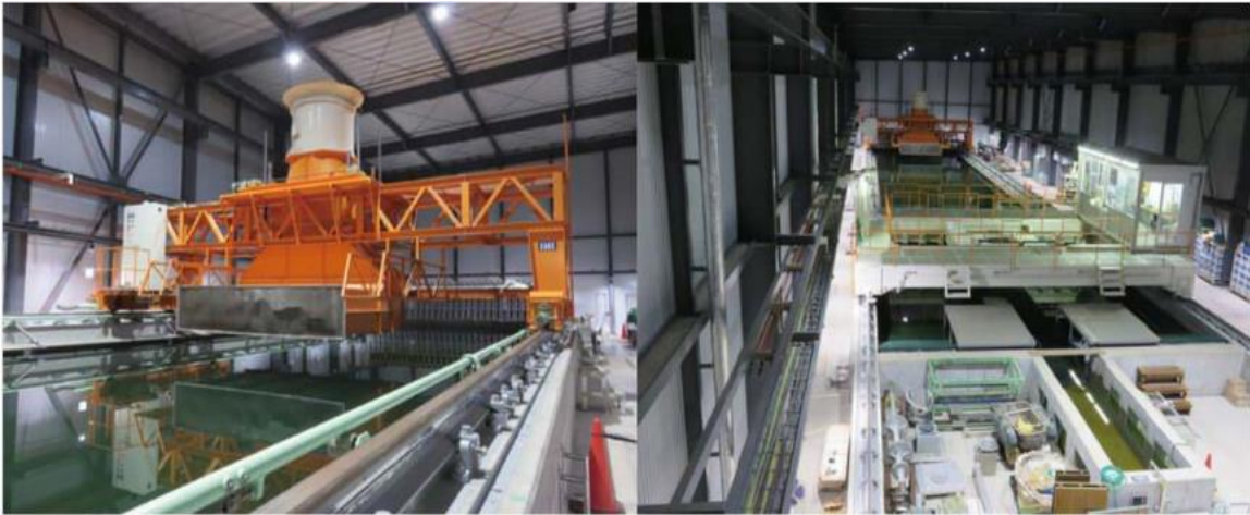
Fig. 3-2 海洋工学水槽造波機および実験場
