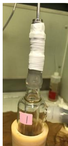
図 3-16 最短化したコネクタ部分
