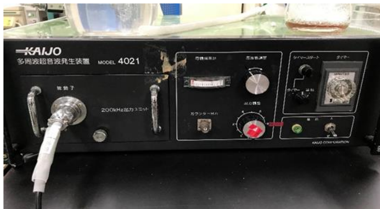
図 2-8 : 高出力超音波照射器
