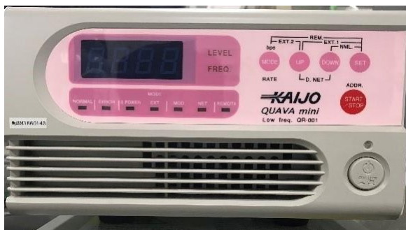
図 2-9：低出力低周波超音波照射器
