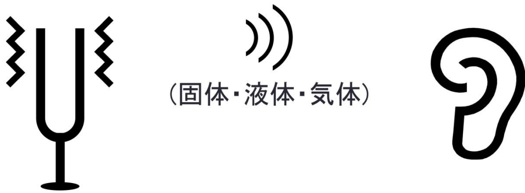
Fig. 2.2-1 音の発生 (振動→媒質→耳)
