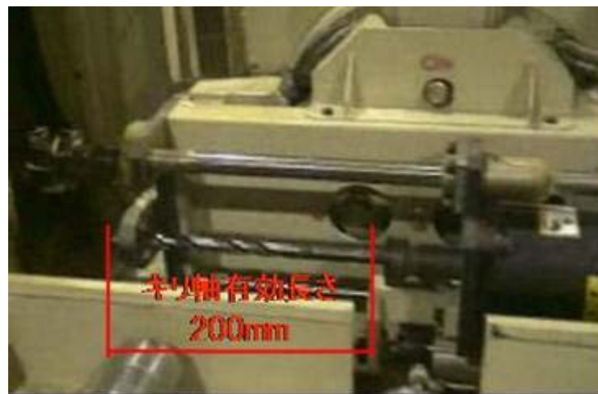
図 2-9 キリ軸（木口加工機）
