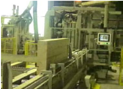
図 2-15 ロールーコンベアにより材がライン上を流れる
