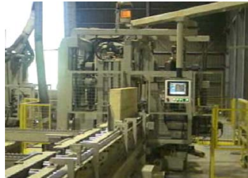
図 2-15 ロールーコンベアにより材がライン上を流れる
