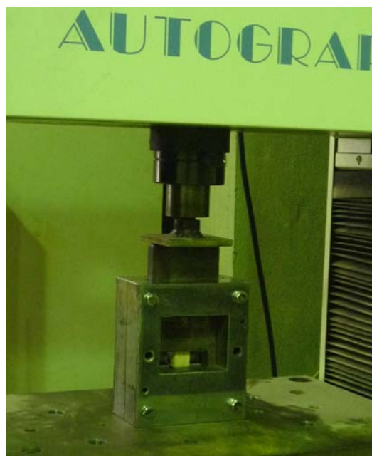
図 2-33 JIS イス型せん断試験の状況
