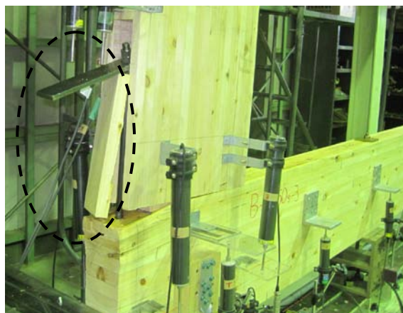
梁柱接合部試験 B105s
