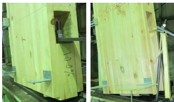
せん断破壊（ブロック） せん断破壊（ボルト曲げ）
