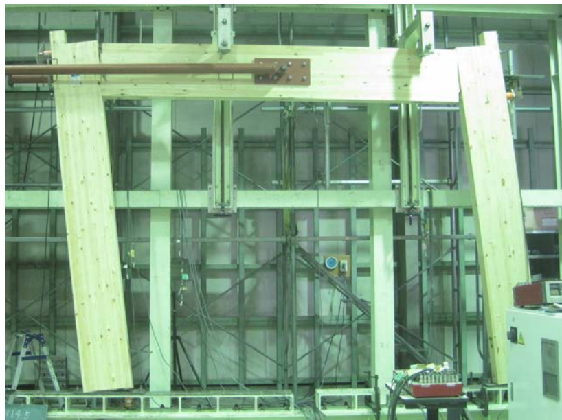
図 1-12 材せい寸法の影響（門型フレーム試験 4P）
