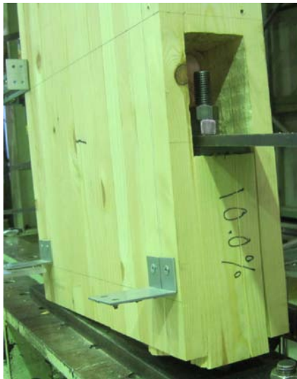
(a) せん断破壊（ブロック）
