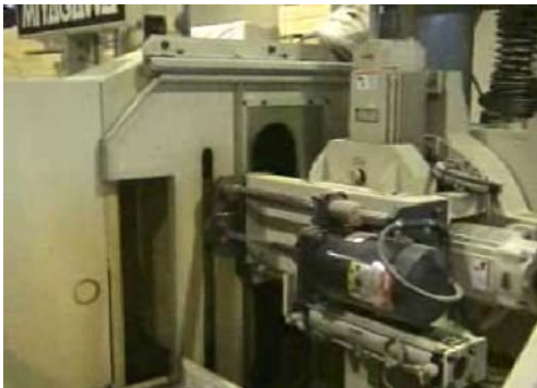
図 2-16 木口加工機による加工
