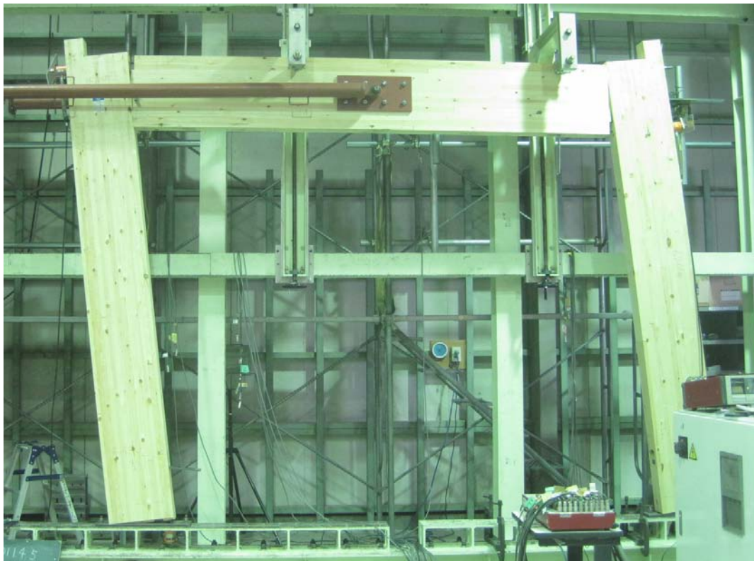
図 3-12 門型フレームの左右の接合部の回転角の関係（門型フレーム試験 4P）
