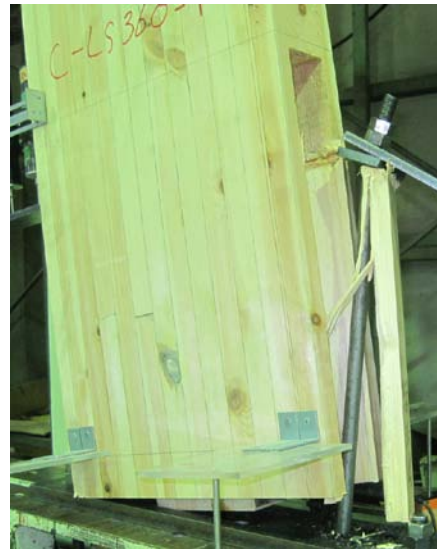
(b) せん断破壊（ボルト曲げ）
