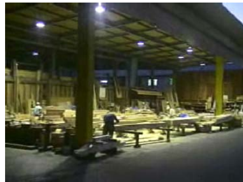
図 2-24 プレカット工場の手加工作業場
