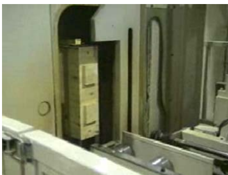
図 3-8 加工が終了した梁仕口
