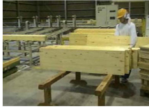
図 2-20 人力によりラインより搬出する
