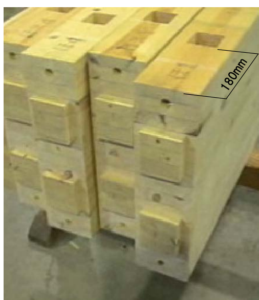
図 3-4 プレカット加工による梁仕口
