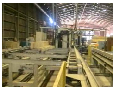
図 2-11 プレカット工場の横架材加工ラインの構成例（出典：宮川工機 MPS-V8 仕様書）
