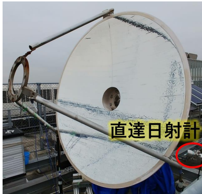
図 2.15 集光器に固定された直達日射計.
