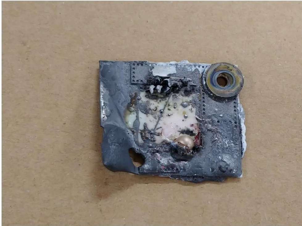
図 2.11 熱交換器との間の伝熱性能が不十分であったために焼損した太陽電池.
