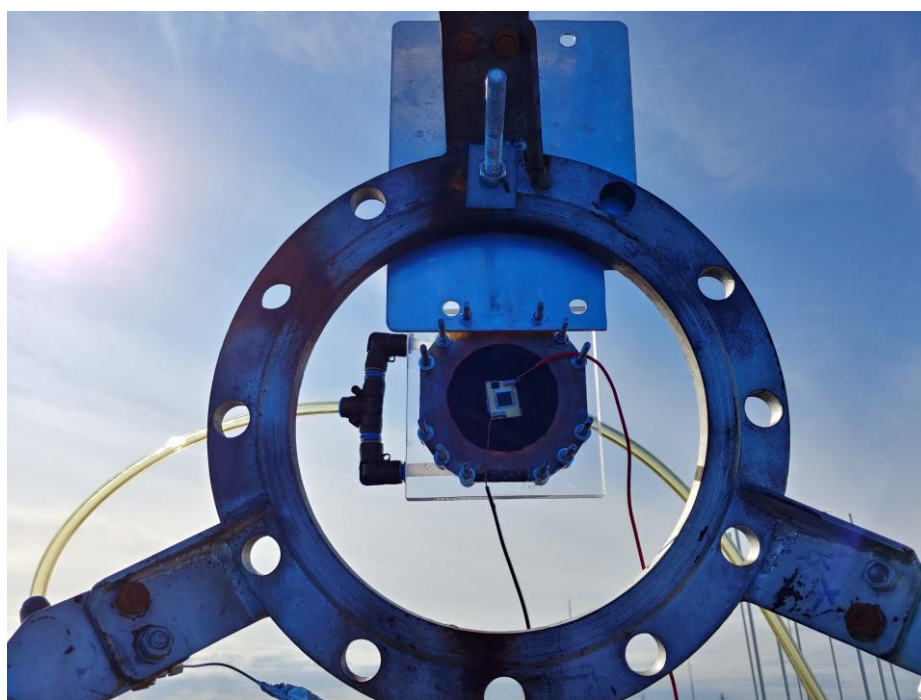
図 2.17 熱交換器を集光器に固定した様子。
