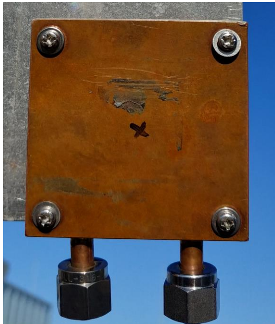
図 3.2 実験に用いる 6 cm 四方の銅製正方形熱交換器.
