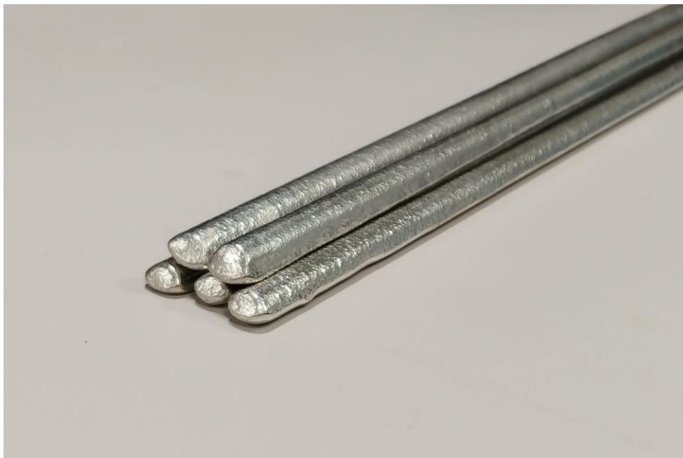
図 2.12 太陽電池と熱交換器とのはんだ付けに用いた \text{Bi58Sn42} のはんだ棒. このはんだの融点は 139\text{ }^{\circ}\text{C} と, JIS 規格品のはんだでも特に低い値をとる.
