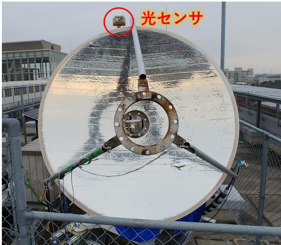
図 2.5 太陽追尾に用いる光センサ(集光器上部, 赤枠内).
