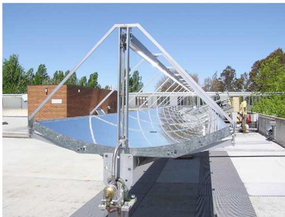
図 1.15 Coventry が用いた CPVT[28]. 放物線を断面形状とする反射鏡を用いた、集光倍率 37 倍のシステムである.
