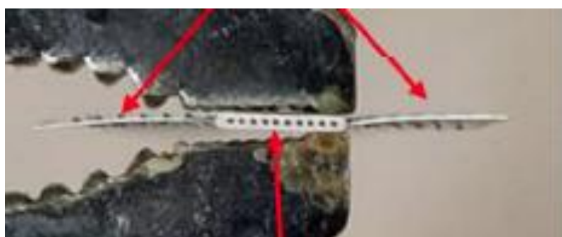
図 2- 2 扁平多孔管 Type2 の断面図 (p=plane, l=louver)
