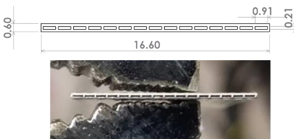
図 2-1 フィンレス熱交換器 Type1 の断面図
