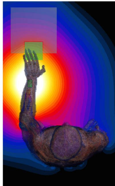
図 6-39 一電極送信機での電界強度分布 (受信電極大, 上面)
