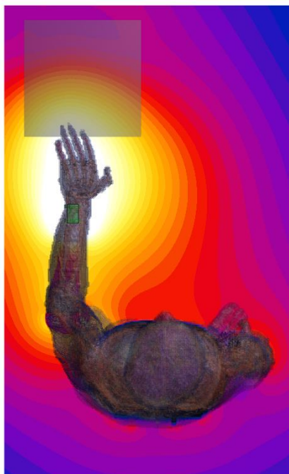
図 6-23 二電極送信機での電界強度分布 (36 mm, 上面)
