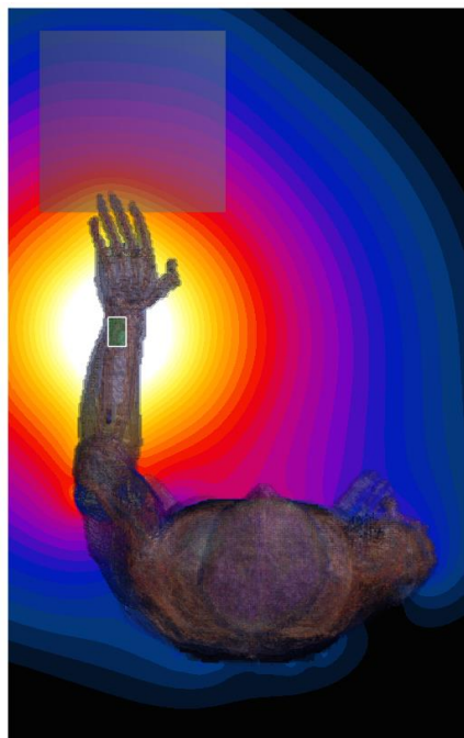
図 6-8 一電極送信機での電界強度分布 (36 mm, 上面)
