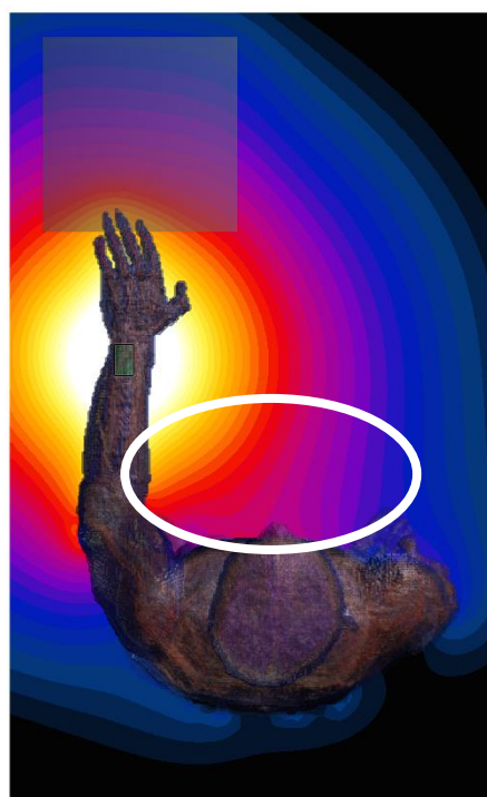
図 7-4 一電極送信機での電界強度分布 (肘を曲げる, 上面)
