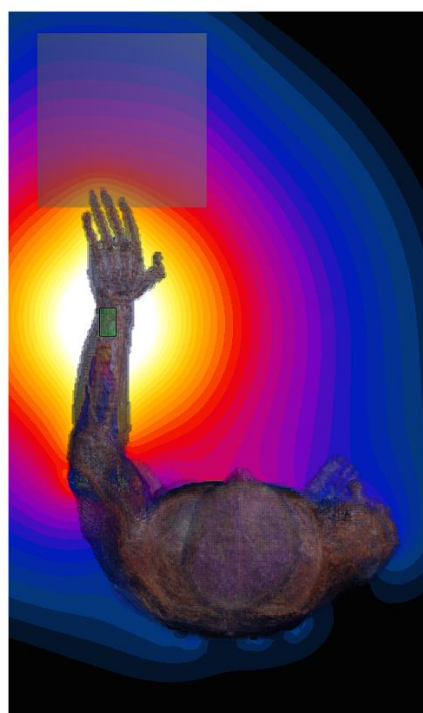
図 6-10 一電極送信機での電界強度分布 (40 mm, 上面)
