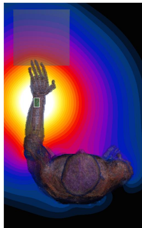
図 6-6 一電極送信機での電界強度分布 (12 mm, 上面)
