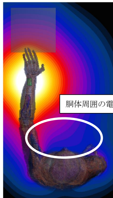
図 7-6 一電極送信機での電界強度分布 (肘を伸ばす, 上面)
