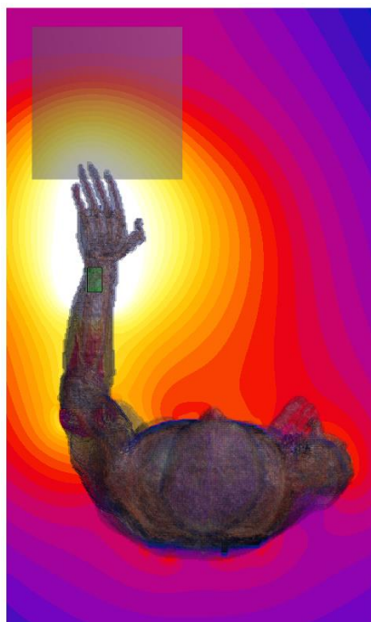
図 6-25 二電極送信機での電界強度分布 (40 mm, 上面)
