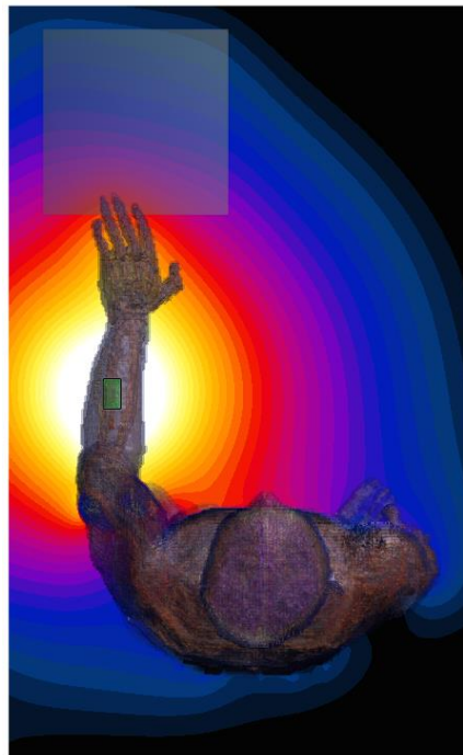
図 5-7 一電極送信機での電界強度分布 (234 mm, 上面)
