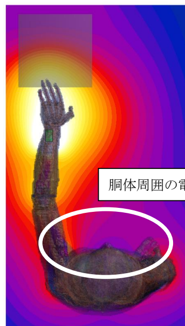
図 7-14 二電極送信機での電界強度分布 (肘を伸ばす, 上面)
