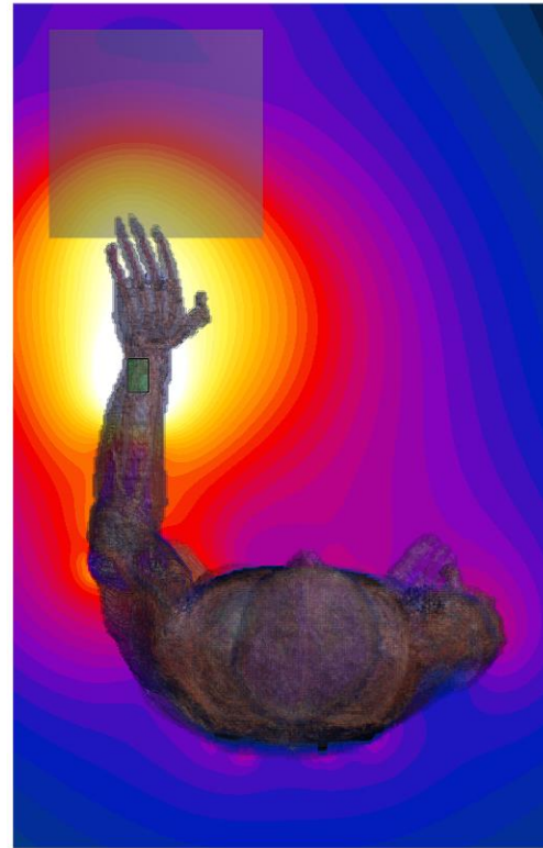
図 6-21 二電極送信機での電界強度分布 (12 mm, 上面)
