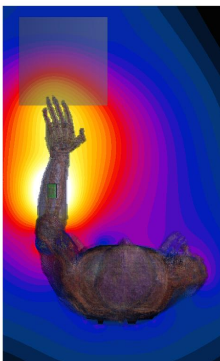
図 5-33 二電極送信機での電界強度分布 (234 mm, 上面)
