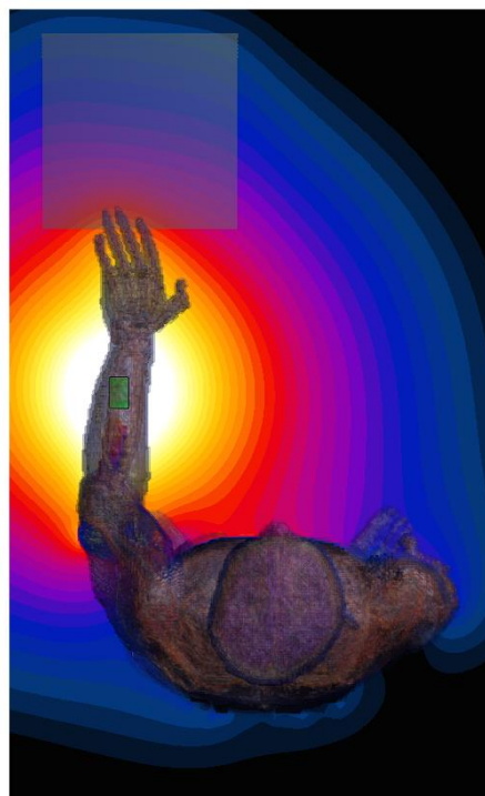
図 5-5 一電極送信機での電界強度分布 (203 mm, 上面)
