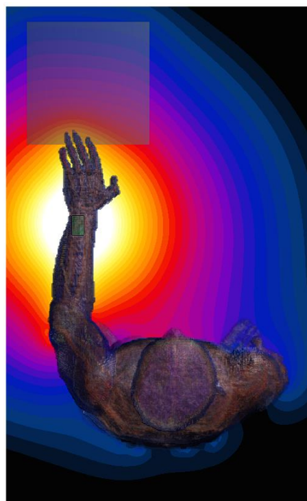
図 5-3 一電極送信機での電界強度分布 (158 mm, 上面)
