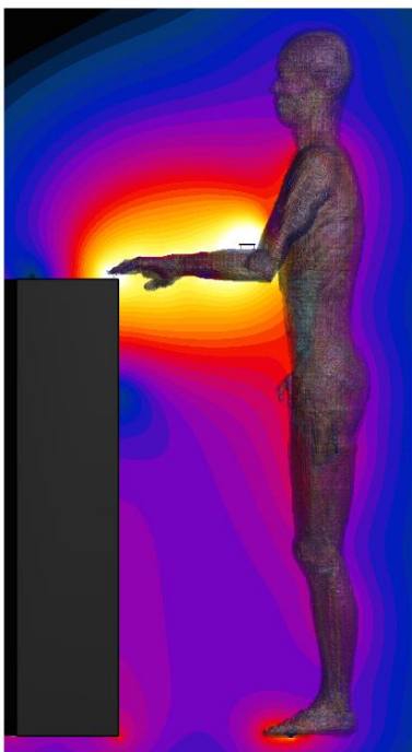
図 5-36 二電極送信機での電界強度分布 (310 mm, 左側面)
