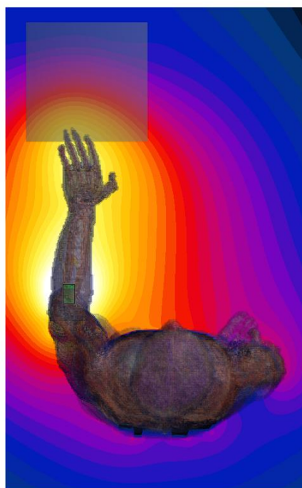
図 5-37 二電極送信機での電界強度分布 (310 mm, 上面)
