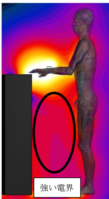
図 6-22 二電極送信機での電界強度分布 (36 mm, 左側面)
