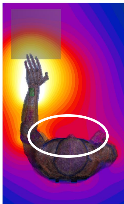
図 7-12 二電極送信機での電界強度分布 (肘を曲げる, 上面)
