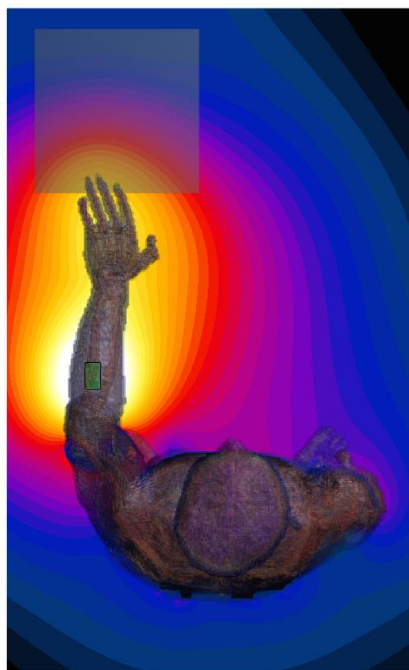
図 5-35 二電極送信機での電界強度分布 (270 mm, 上面)
