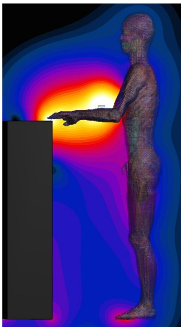
図 5-34 二電極送信機での電界強度分布 (270 mm, 左側面)
