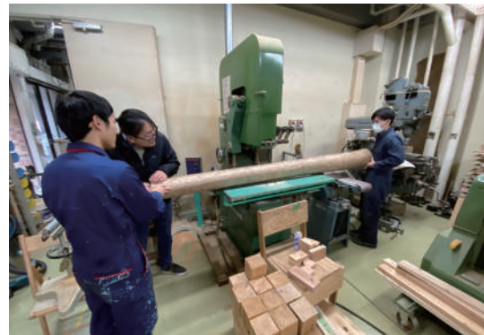
fig3-3-5. 角材を取り出す作業
