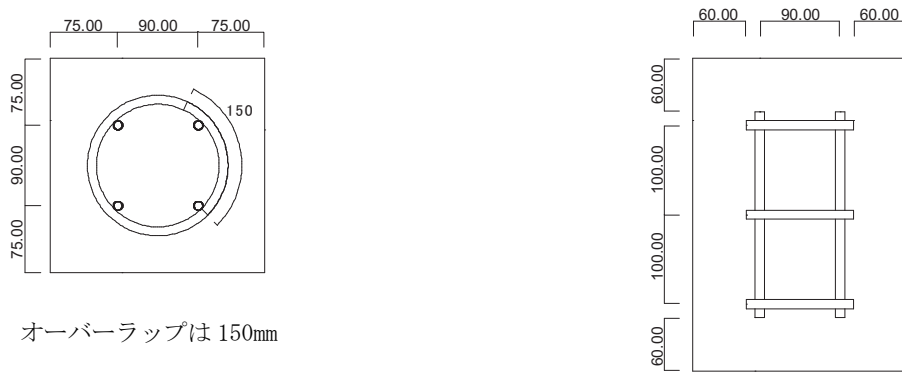
図 9 一斗缶基礎配筋図(1/10)
