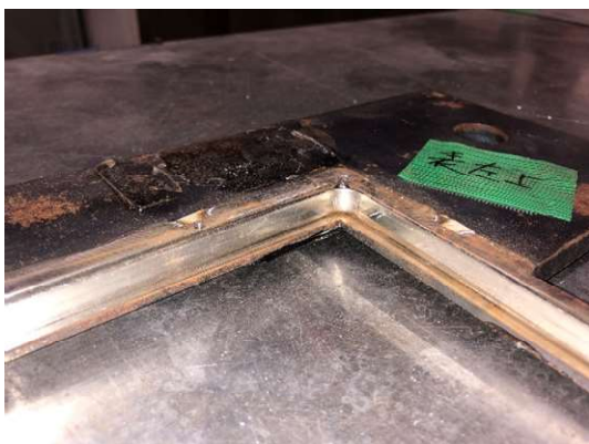
図 2.30 実験後の錫の様子 (小型試験体 4)
