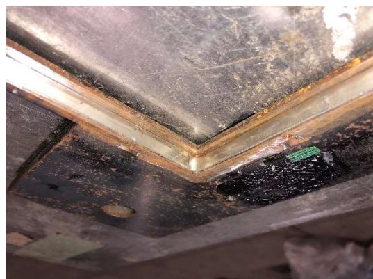
図 2.30 実験後の錫の様子 (小型試験体 4)
