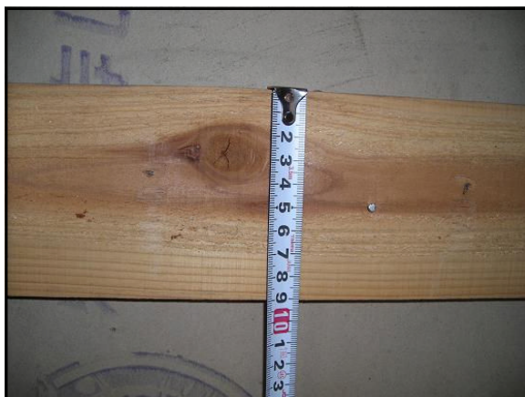
図 2-13 貫の寸法調査 15mm × 90mm
