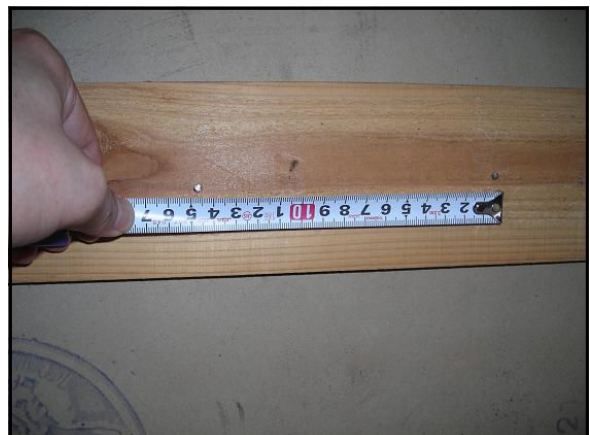
図 2-12 貫に打たれた釘ピッチ調査
