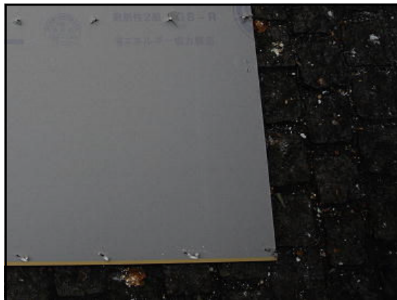
図 2-46 石膏ボードの破壊
