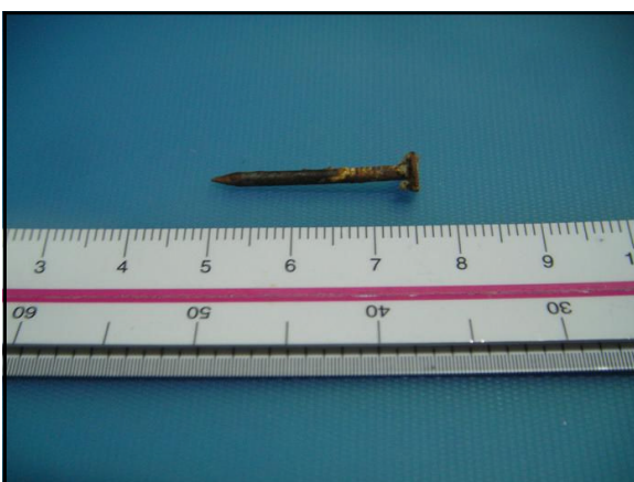
図 2-8 I 邸 9mm ラスボード取り付け釘
