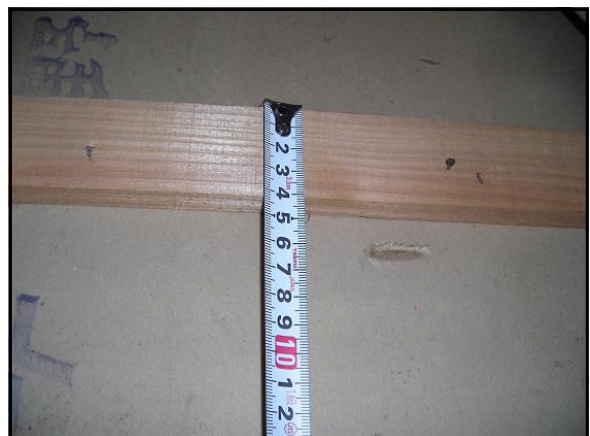
図 2-14 半貫の寸法調査 15mm × 45mm
