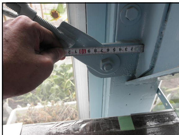
図 3-22 丸鋼ブレース・ガセットプレート調査
