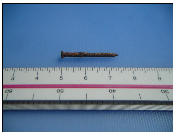
図 2-6 M 邸ラスボード取り付け釘 8 分釘
