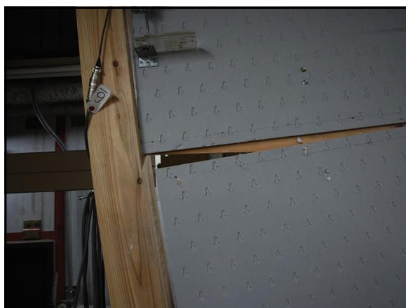
図 2-43 引き切り時のラスボードの脱落
