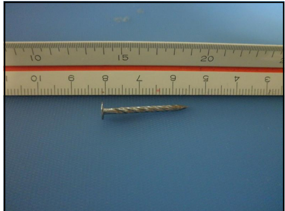
図 2-10 石膏ボード取り付けスクリュー釘 25mm
