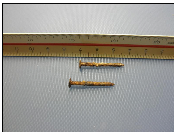
図 2-5 S 邸ラスボード取り付け釘 8 分釘
