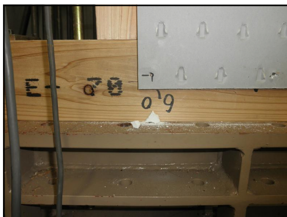
図 2-41 試験体 5 石膏ボード材の崩れ
