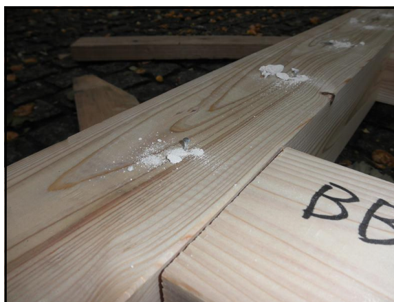
図 2-44 実験後の釘の状態
