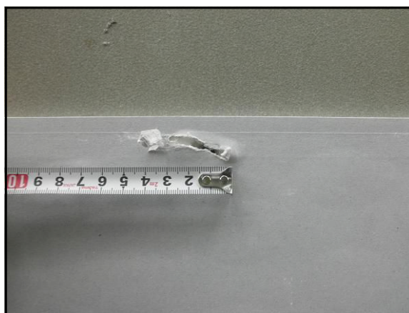
図 2-42 ラスボードの破壊
