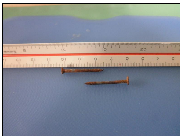
図 2-7 F 邸ラスボード取り付け釘 8 分釘
