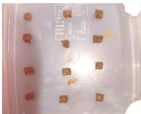
図 3.7.1 サンプルスポンジの様子 乾燥を防ぐため濡れキムワイプを配置した
