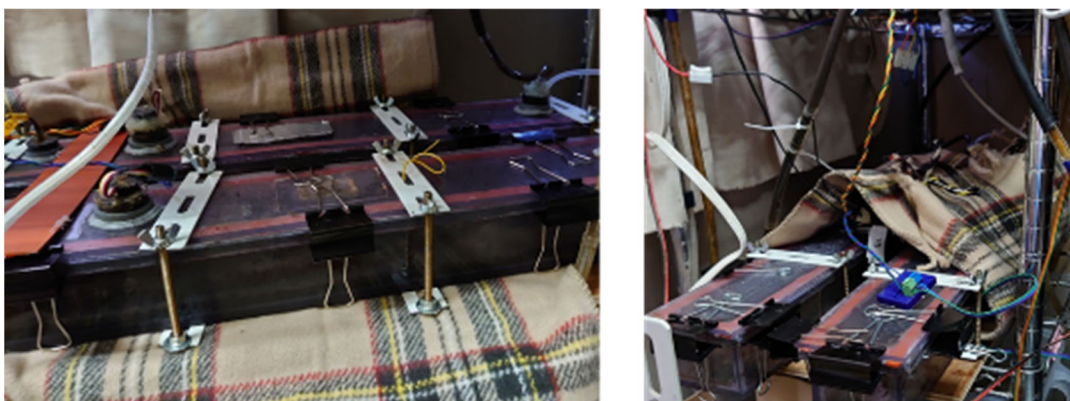
図 3.6.1 毛布で包んだ実験リアクター
