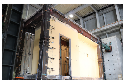
写真1 乾式間仕切り壁の試験体外観
