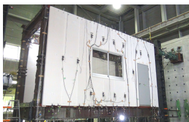
写真2 ALC外壁の試験体外観
