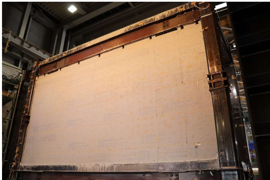
写真2 層間変形角 1/33 を与えた後に上張りボードを剥がしたときの様子
