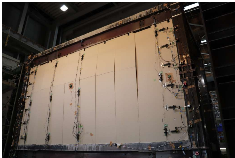
写真1 層間変形角-1/33 時の様子（ボードが脱落する直前）
