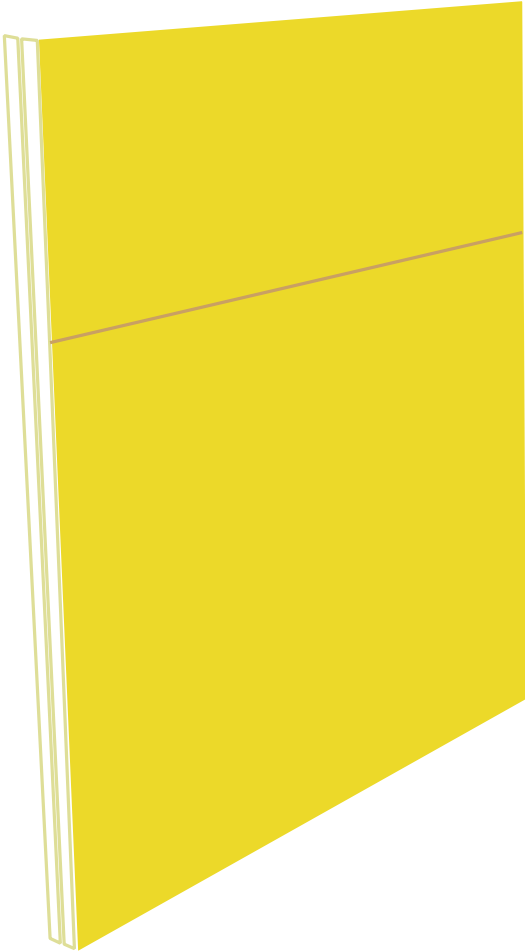
図 24 B 面に生じたボード目地の浮きのイメージ図
