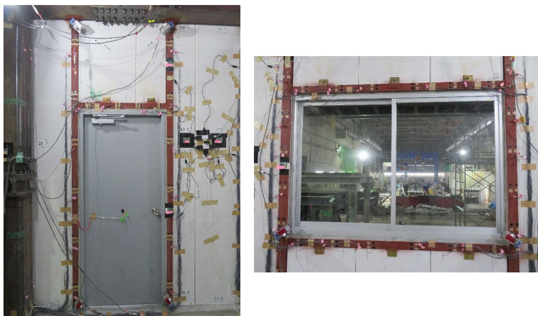
写真 4-2 室内側から見た開口部の様子（写真左：鋼製扉、写真右：引き違い窓）
