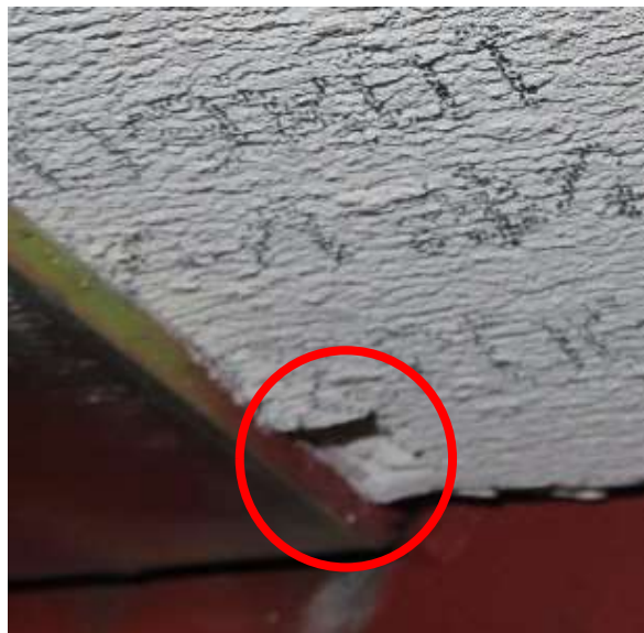
写真 1 1/50 載荷後のボード底面の様子
