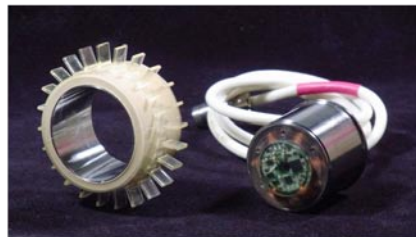
図 5-11 製作した左心用 HFP a: 外観, b: 構成部品
