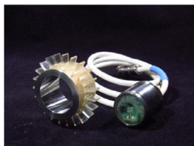
図 5-18 製作した右心用 HFP a: 外観, b: 構成部品
