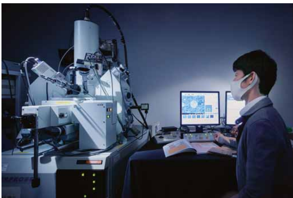
電界放出型電子線マイクロアナライザFE-EPMAを用いて、中生代の化石や鉱物を観察しているところ
