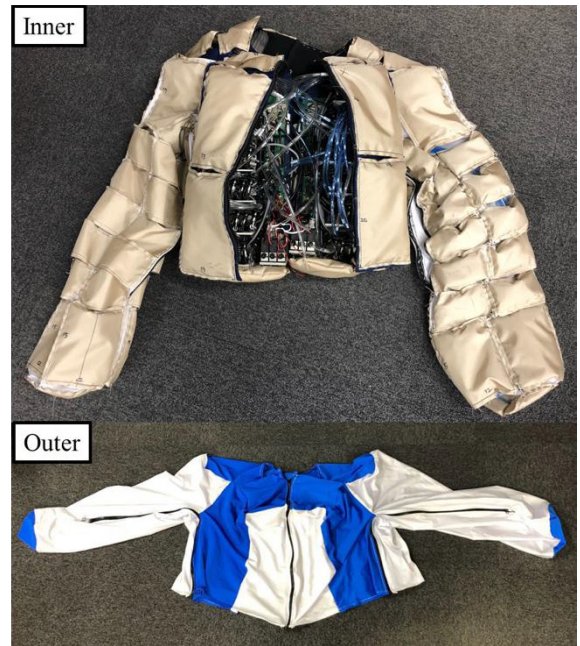
図 6 空気室型柔軟触覚センサを備えた HRP-4R 用衣服型外装の概要
