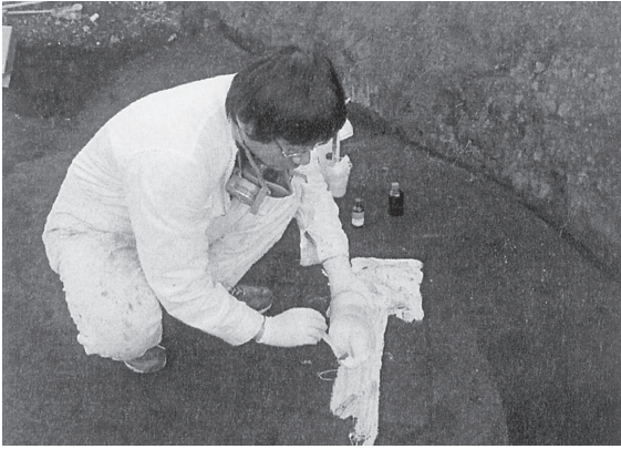
写真1 シリコンゴムを土層付着実験
