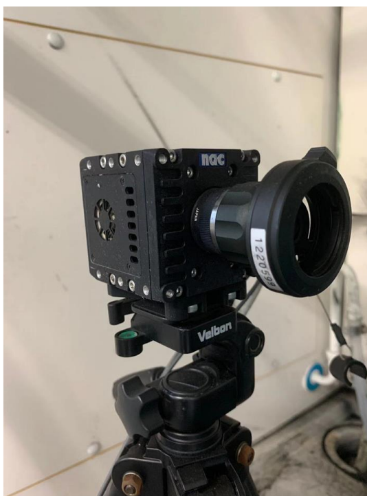
Fig. 3.2.13 nac 製の高速度カメラ MEMORECAM Q1v
