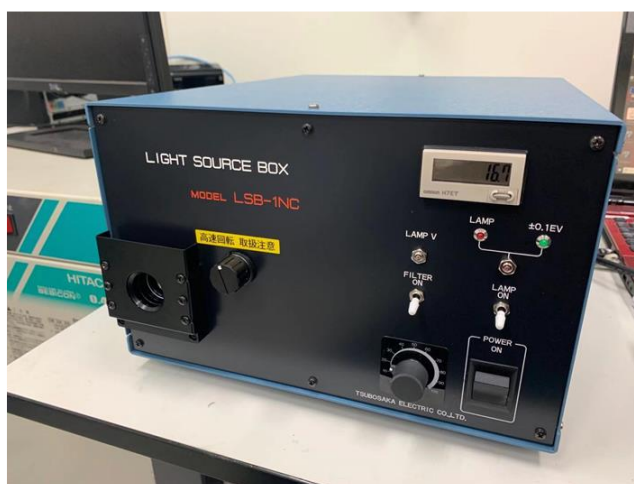
Fig. 3.2.15 ナック製温度校正用標準光源 LSB-1NC2
