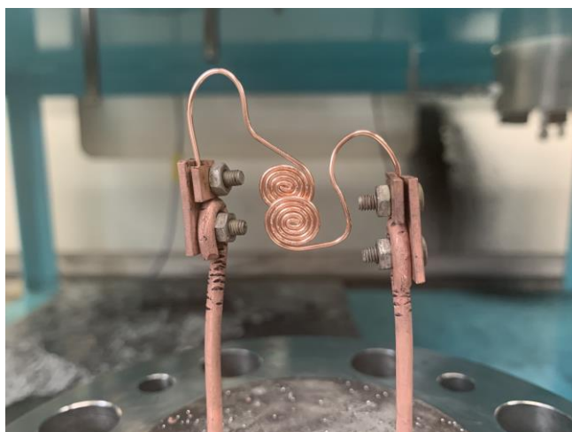
Fig. 3.1.4 渦巻電極によるアーク放電法
