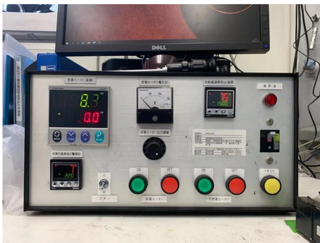
Fig. 3.2.5 ヒーター制御システム
