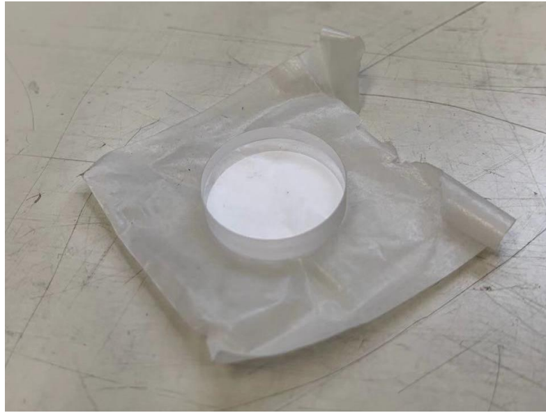
Fig. 3.2.2 直径 22mm 厚さ 5mm の石英ガラス
