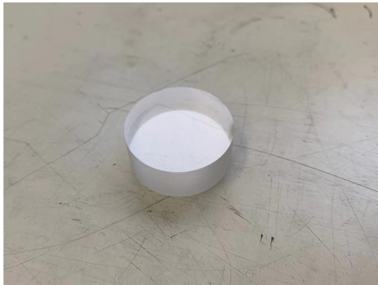
Fig. 3.2.3 直径 36mm、厚さ 14mm のサファイア結晶板
