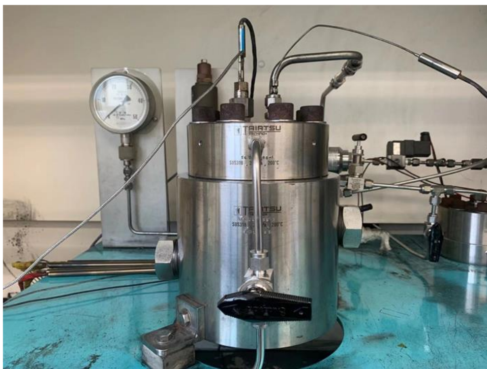
Fig. 3.2.1 ステンレス鋼製圧力容器
