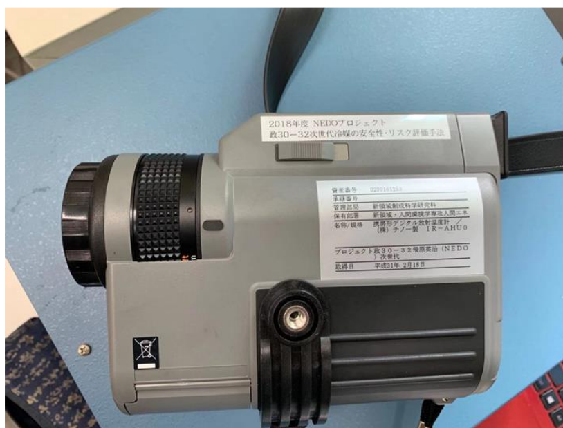
Fig. 3.2.16 チノ製の携帯形デジタル放射温度計 IR-AHU0
