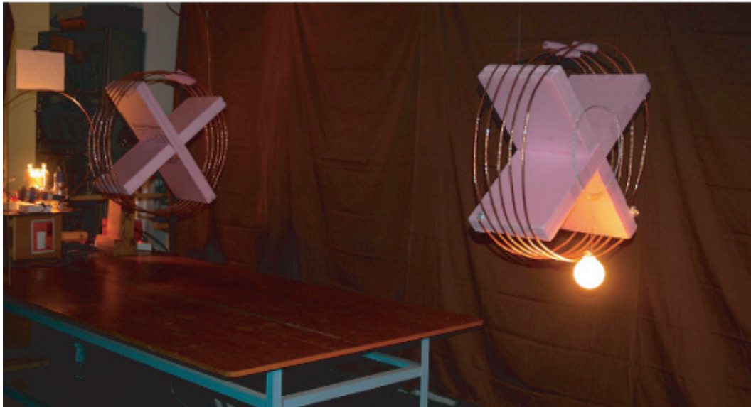
図 1.10: MIT によるワイヤレス電力伝送の実験：2m のエアギャップで 60W を伝送 [19]
