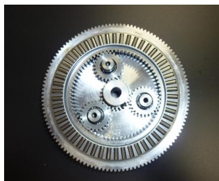
図 5.5 研究室にて試作した遊星歯車
