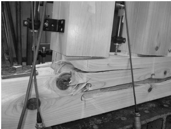
図 4.2.1-3 75-2 引張側柱脚の節(目切れ)
