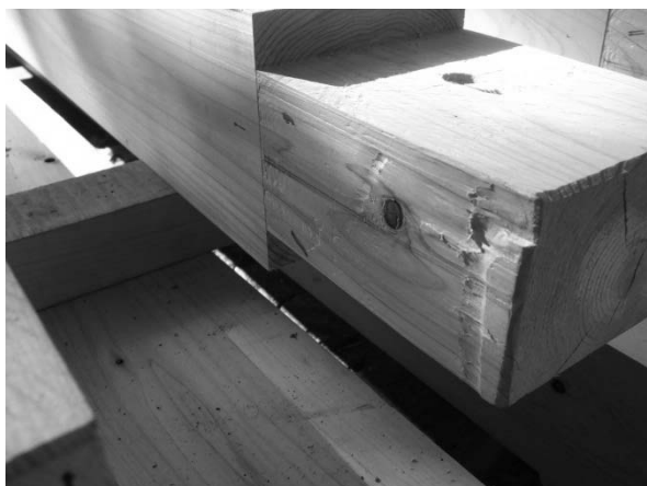
図 4.2.1-7 75-2 終局時引張側の柱脚詳細
