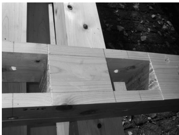
図 4.2.1-12 75-2 土台上端のめり込み痕
