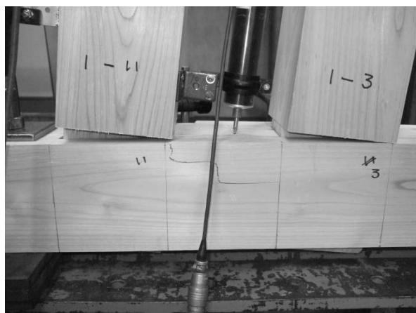
図 4.2.1-14 60-1 ほぞのこじりによる土台の割れ 図 4.2.1-15 60-2 柱ほぞの曲げ破壊
