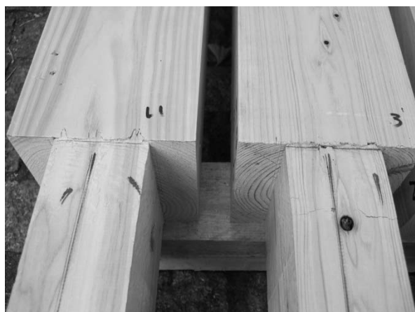
図 4.2.1-20 60-2 ほぞ付け根めり込み破壊 図 4.2.1-21 ほぞの曲げ破壊と食い込み摩擦
