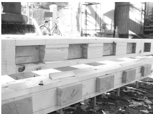
図 4.2.1-11 75-2 土台下端のせん断破壊
