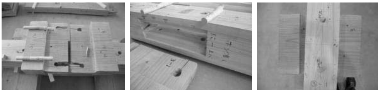
タイプⅢ(上下ほぞ) ほぞのせん断と込栓の曲げ破壊、ほぞの曲げ破壊が観察された。 左：ほぞせん断、ほぞ曲げ、栓曲げ、中：解体後の柱仕口、右：終局時の横架材拔出し。
