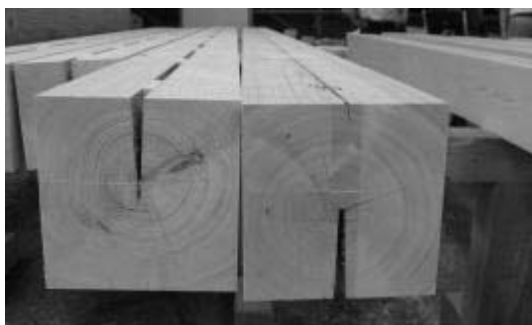
図 2.1.2-2 加工前の柱材(ヒノキ：左)と横架材(米マツ：右)
