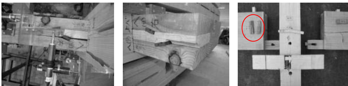
タイプⅣ(上車知) ①車知栓の回転に伴う横架材の開きによる柱割れ：左図、②雇いほぞの車知栓先のせん断：中図、③車知栓の圧縮破壊：右図の3つの破壊モードが観察された。
