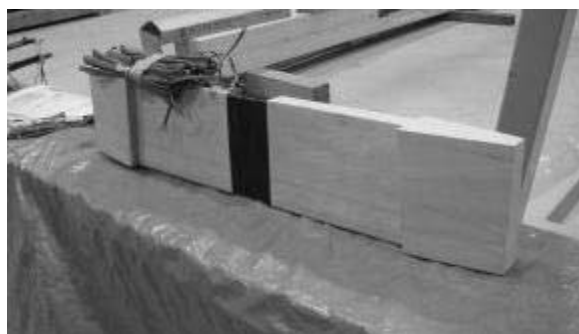
図 2.1.2-4 雇い鎌設置の歪みゲージ
