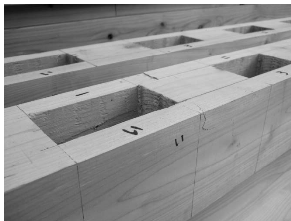
図 4.2.1-22 60-2 土台上端のめり込み痕 図 4.2.1-23 60-1 柱の回転による土台の割れ
