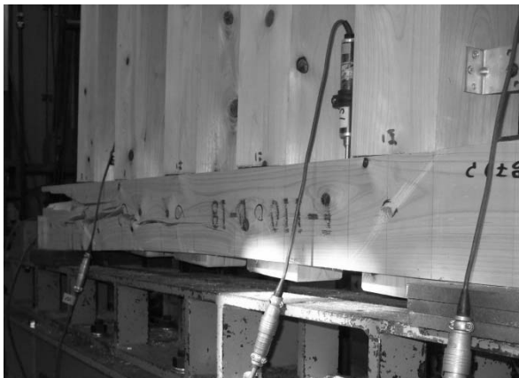
図 4.2.1-5 75-3 土台の曲げせん断破壊
