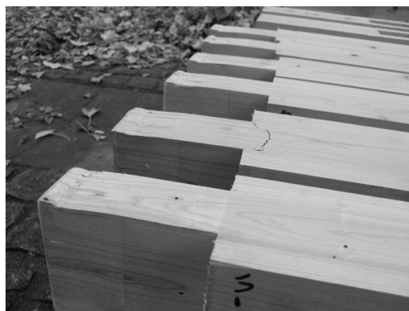
図 4.2.1-20 60-2 ほぞ付け根めり込み破壊 図 4.2.1-21 ほぞの曲げ破壊と食い込み摩擦
