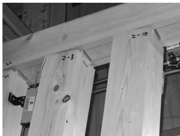
図 4.2.1-14 60-1 ほぞのこじりによる土台の割れ 図 4.2.1-15 60-2 柱ほぞの曲げ破壊
