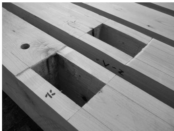
図 4.2.1-22 60-2 土台上端のめり込み痕 図 4.2.1-23 60-1 柱の回転による土台の割れ
