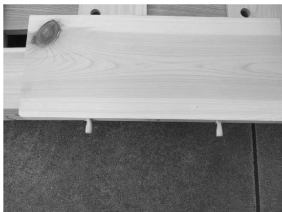
図 5.2.2-10 ダボの曲げせん断変形
