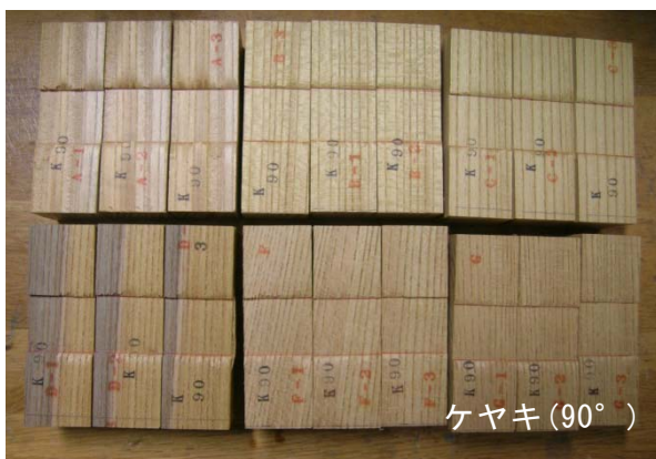
図 6.2.2-3 試験後の供試体(加圧面)
