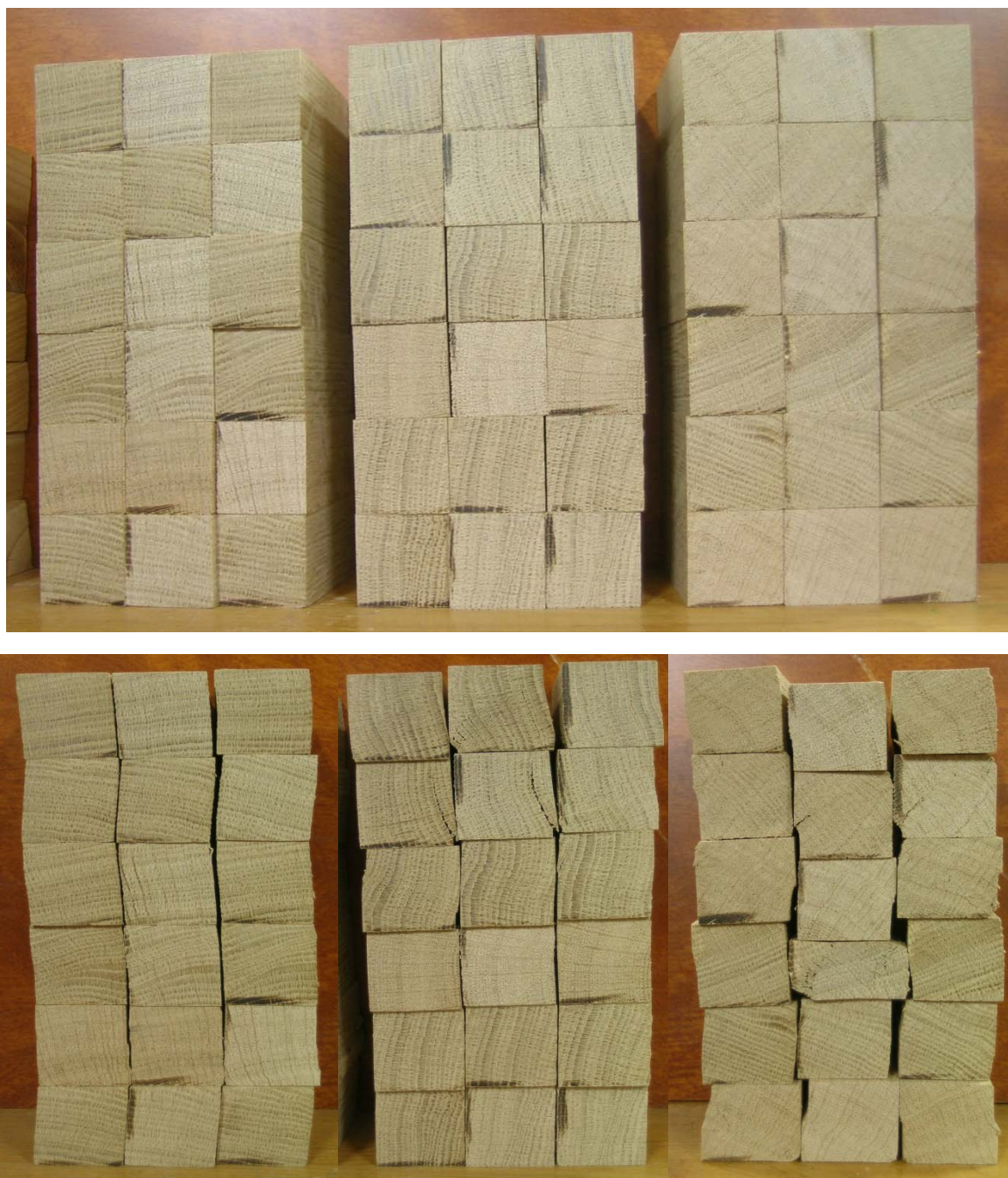
図 6.2.1-4 ナラ 試験前(上)と試験後(下)の比較 左から 0° , 90° , 45°
