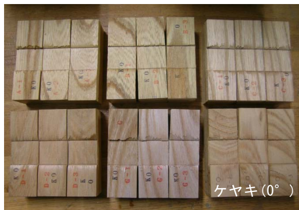
図 6.2.2-3 試験後の供試体(加圧面)
