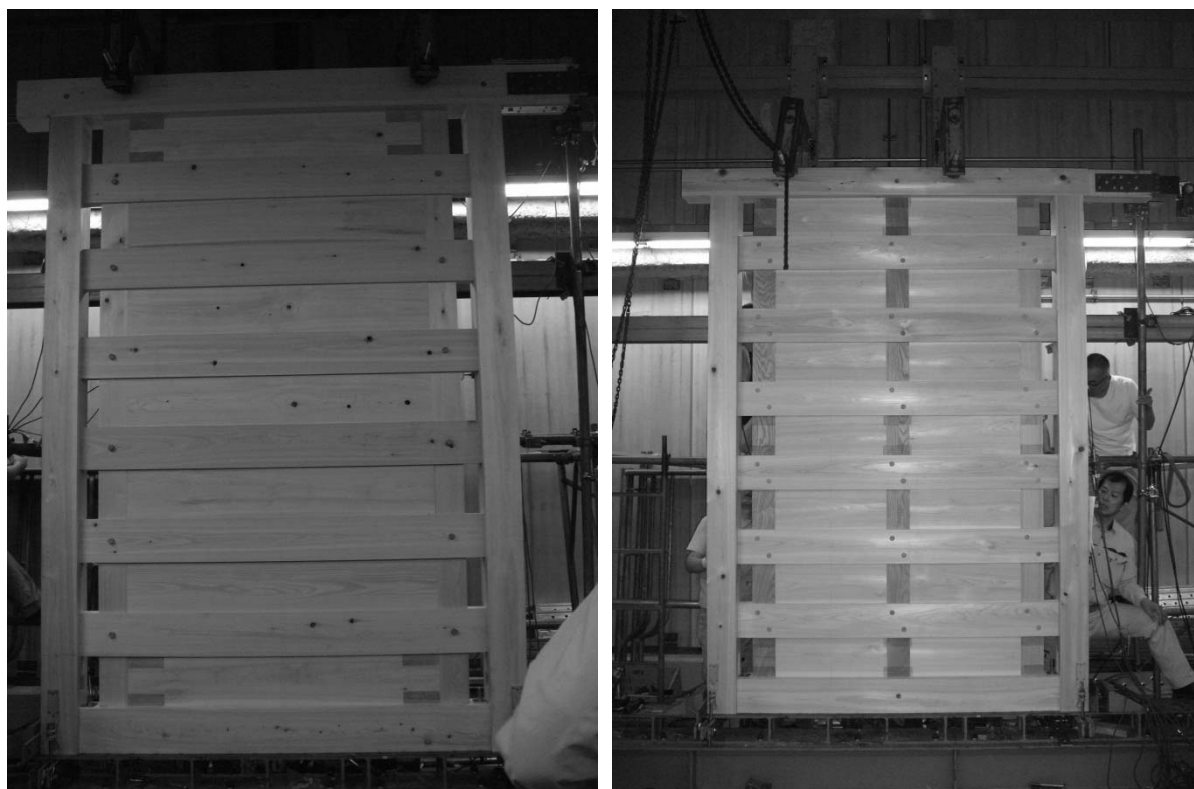
図 5.1.1-1 耐力壁の構成(左：予備試験① 右：予備試験②)
