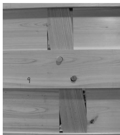
図 5.2.2-6 込栓によるめり込み(横貫) 図 5.2.2-7 たて貫のめり込み(板と貫穴木口による)
