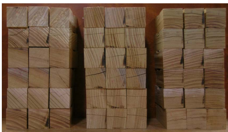
図 6.2.2-2 試験後のケヤキ材木口 左より 45°，90°，0°
