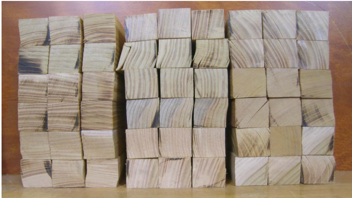
図 6.2.1-2 試験後のカエデ試験体 左から 0° , 90° , 45°
