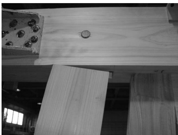
柱／横架材・たて貫／横架材部(めり込み)
