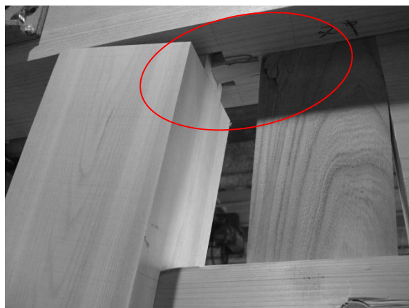
図 5.2.2-3 ほぞ穴間のせん断(桁材) 図 5.2.2-4 たて貫のこじりによるせん断(貫材)
