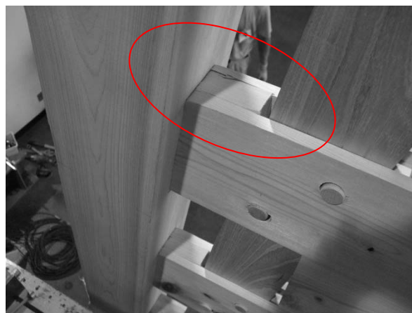
図 5.2.2-3 ほぞ穴間のせん断(桁材) 図 5.2.2-4 たて貫のこじりによるせん断(貫材)
