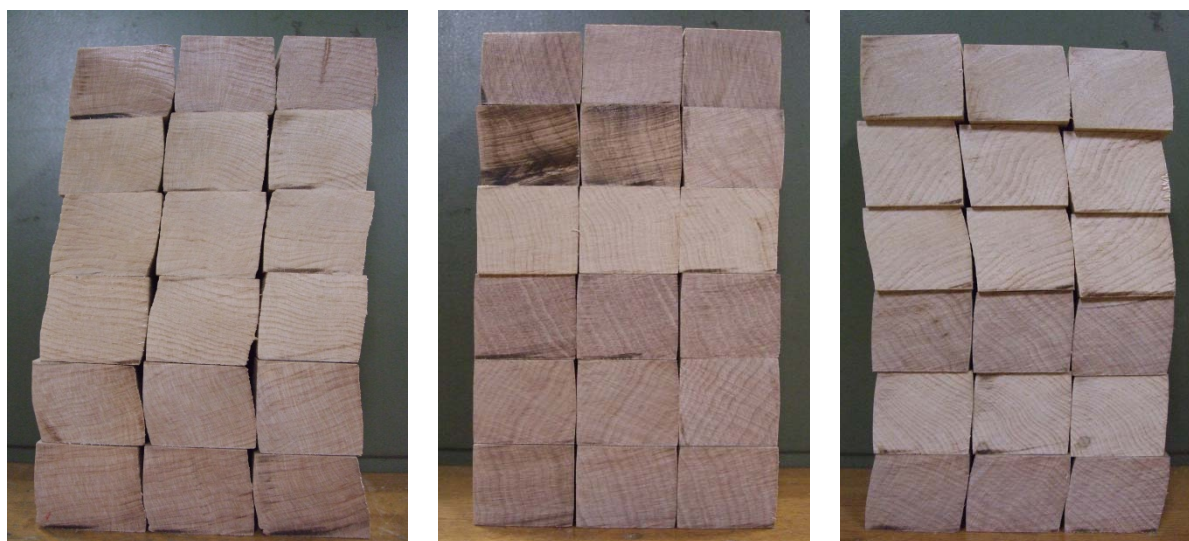
図 6.2.1-1 試験後のカエデ試験体 左から 0^\circ , 90^\circ , 45^\circ
