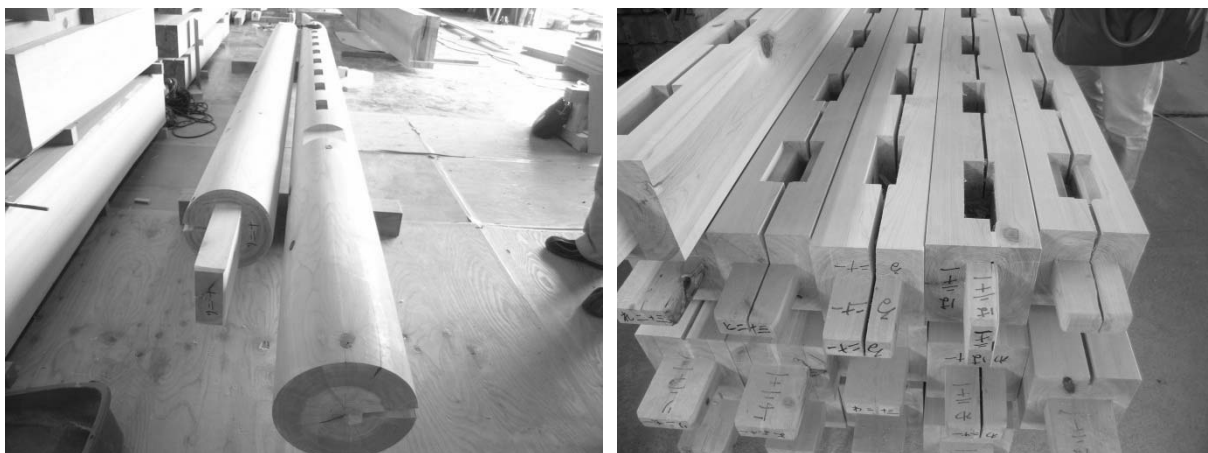
図 5.4.2-1 ヒノキ柱材の貫穴(60×180mm)加工 於 愛知県江南市
