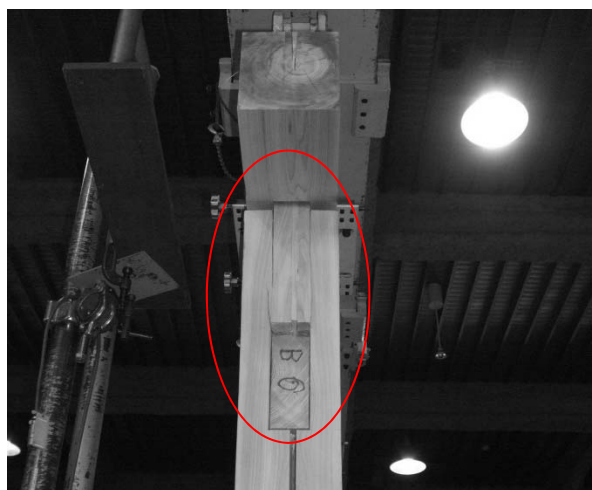
図 5.2.2-4 貫のほぞ穴からのせん断(柱材) 図 5.2.2-5 めり込みに伴う割れ(たて貫材)
