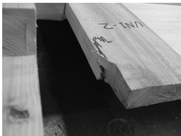
図 5.2.2-8 たて貫頂部の曲げによる割れ
