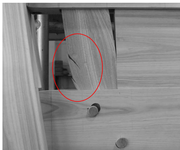
図 5.2.2-4 貫のほぞ穴からのせん断(柱材) 図 5.2.2-5 めり込みに伴う割れ(たて貫材)
