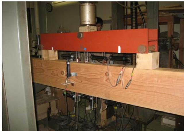
写真 5.1.1 4点曲げ試験
