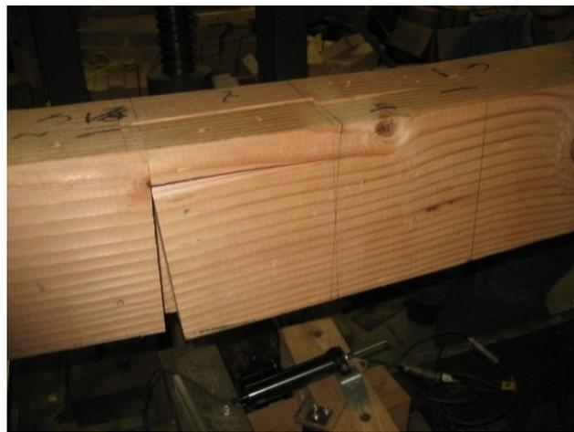
写真 3.1.1 追掛継の胴付の割裂
