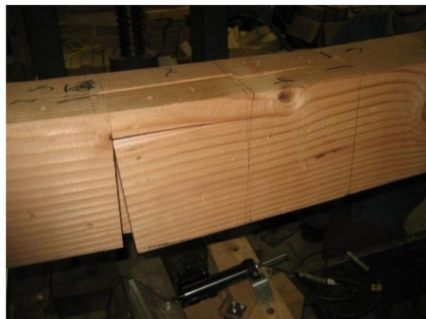
写真 2.1.1 胴付の摩擦による割裂
