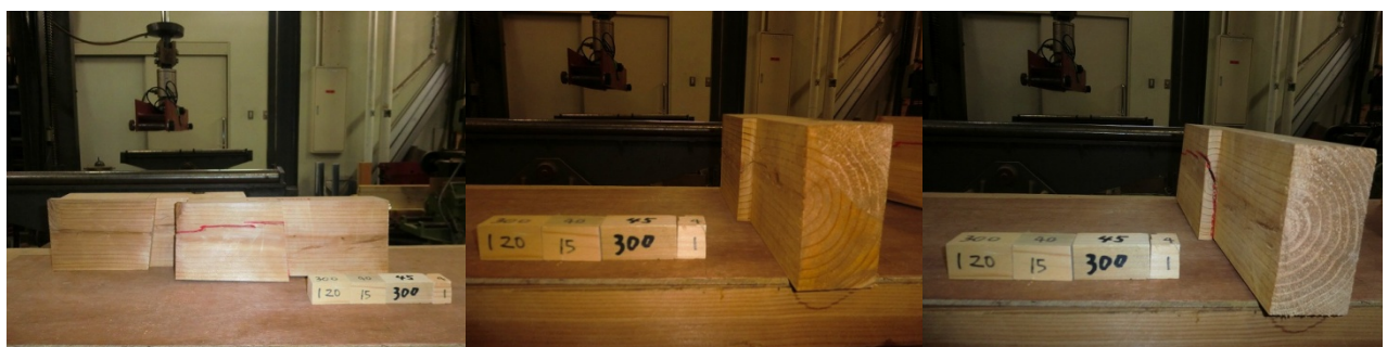
スギ追掛継の4点曲げ試験データ1
