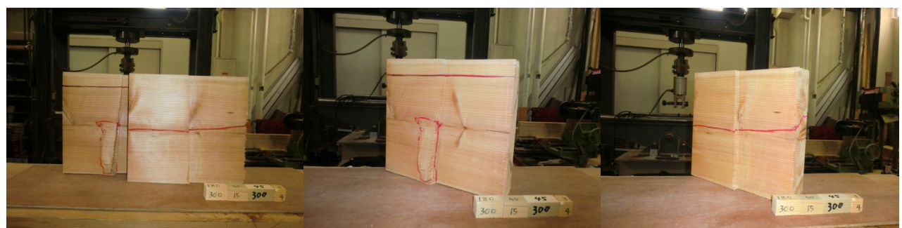
スギ追掛継の4点曲げ試験データ 22
