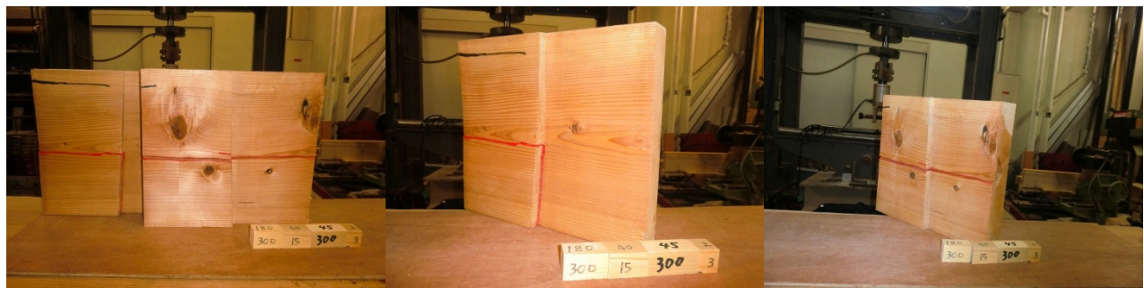
スギ追掛継の4点曲げ試験データ 21
