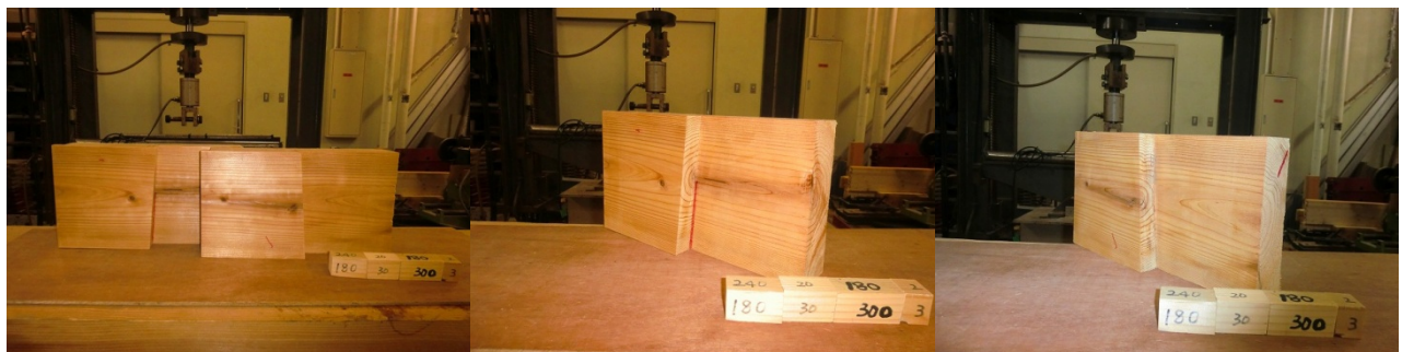
スギ追掛継の4点曲げ試験データ 27
