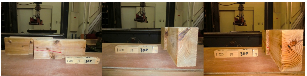
スギ追掛継の4点曲げ試験データ4
