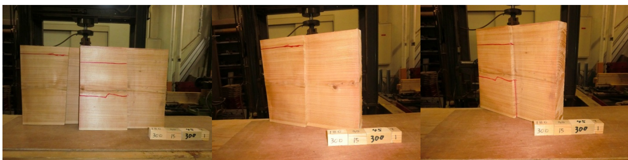
スギ追掛継の4点曲げ試験データ 19
