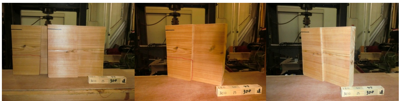
スギ追掛継の4点曲げ試験データ 20
