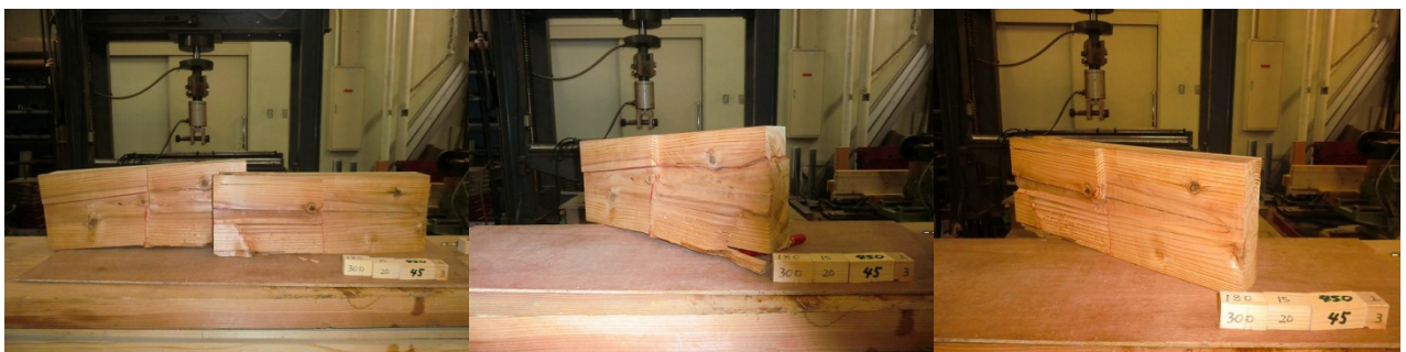
スギ追掛継の4点曲げ試験データ 50
