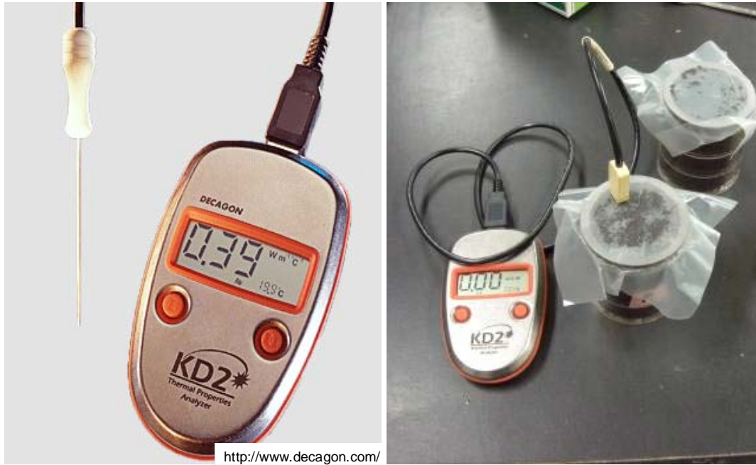
写真 4.1 熱伝導プローブ KD2(左 ; http://www.decagon.com/ ) (右)熱伝導率測定の様子
