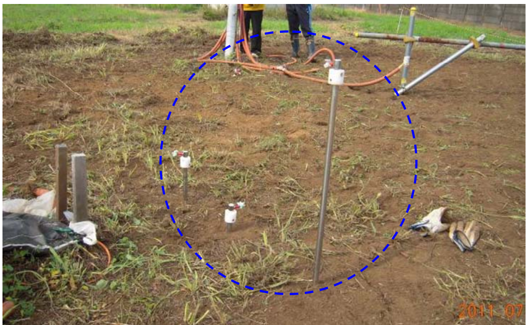
写真 3.10 埋設したガス採取管
