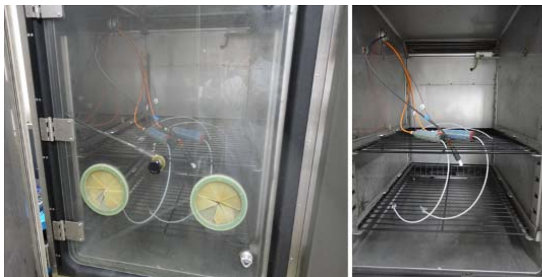
写真 3.9 C-BT-GMS 温度依存性実験の様子 (恒温チャンバ内(左:内扉を閉めたところ 右:内扉の中))
