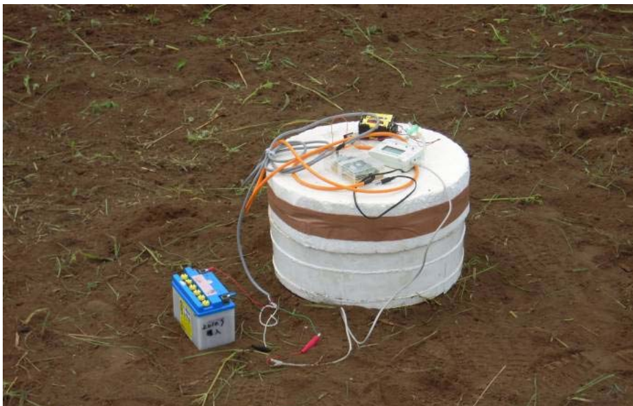
写真 3.11 クローズドチャンバー法による CO 2 フラックス測定
