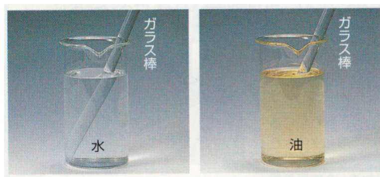
図 2.1: 屈折率のコントラスト差によりガラス棒が消えて見えるというデモンストラーション。
