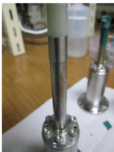
図 4.2.5 SUS パーツと FRP パーツの接合部分（ニトフィックス塗布前）と極薄 SUS パイプの写真
