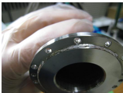
図 4.2.4 SUS パーツにインジウムを接着した状態の写真
