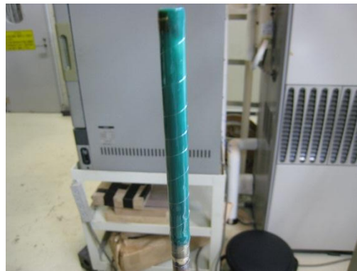
図 4.2.6 SUS パーツと FRP をニトフィックスにより接着した後 釣り糸を巻いた状態の写真
