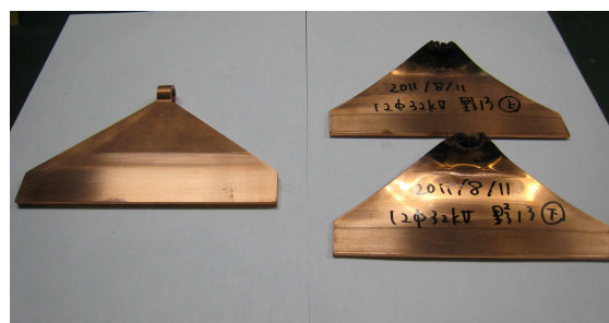
図 4.4 一巻きコイルの磁場発生前後の写真
