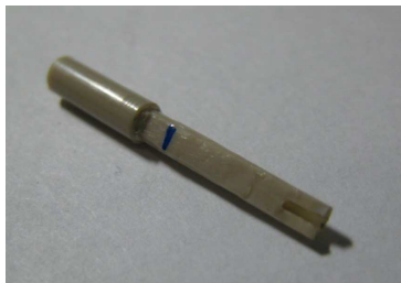
図 4.25 PEEK 製スペーサーの外観 図 4.26 シリコンチューブによる酸素導入路の結合
