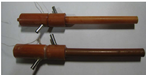
図 4.23 ベークライト製クライオスタットの外観 図 4.24 カーボンナノチューブを塗布した様子
