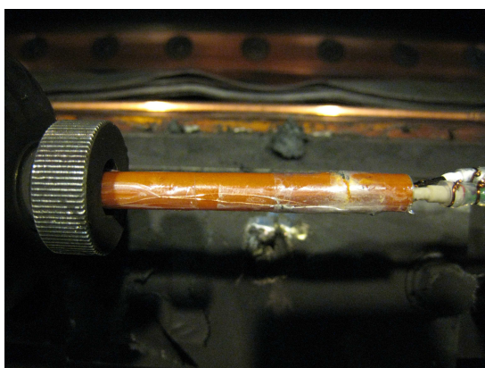
図 4.40 衝撃波による破壊の例
