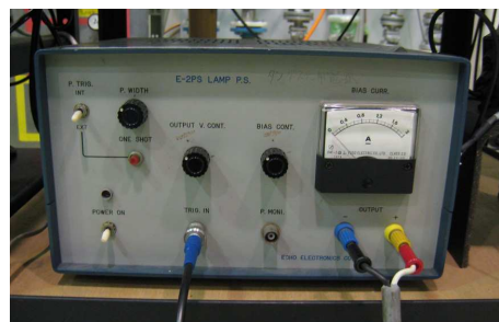
図 4.18 ハロゲンランプ電源
