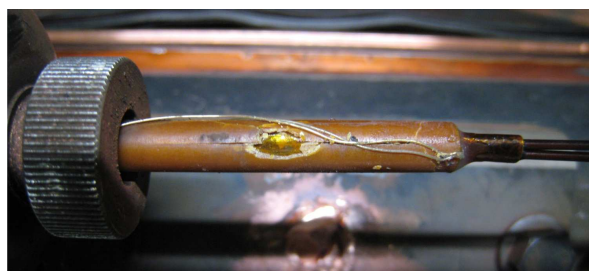
図 4.39 水の付着による異常放電 クライオスタット近傍
