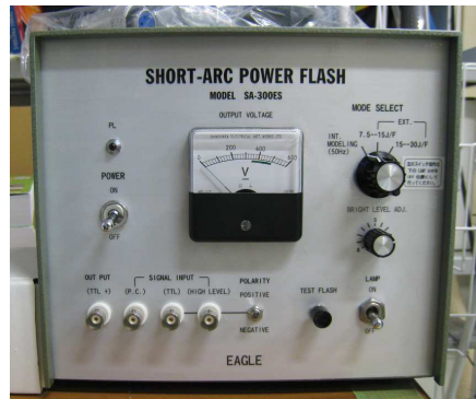
図 4.30 Xe フラッシュランプの電源
