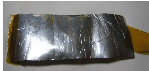
図 4.43 磁場発生後のスーパーインシュレーションシート
