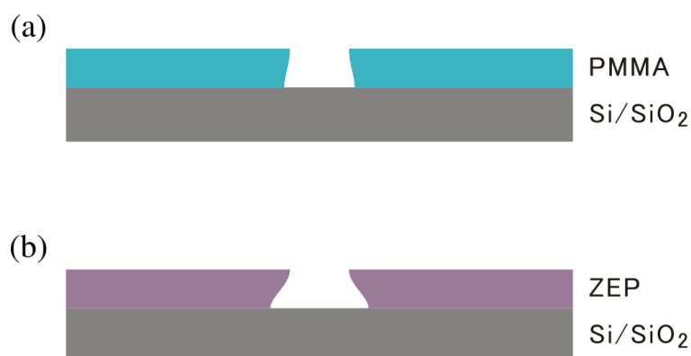
図 3.2 (a)PMMA、及び(b)ZEP レジストを感光・現像した場合の断面。
