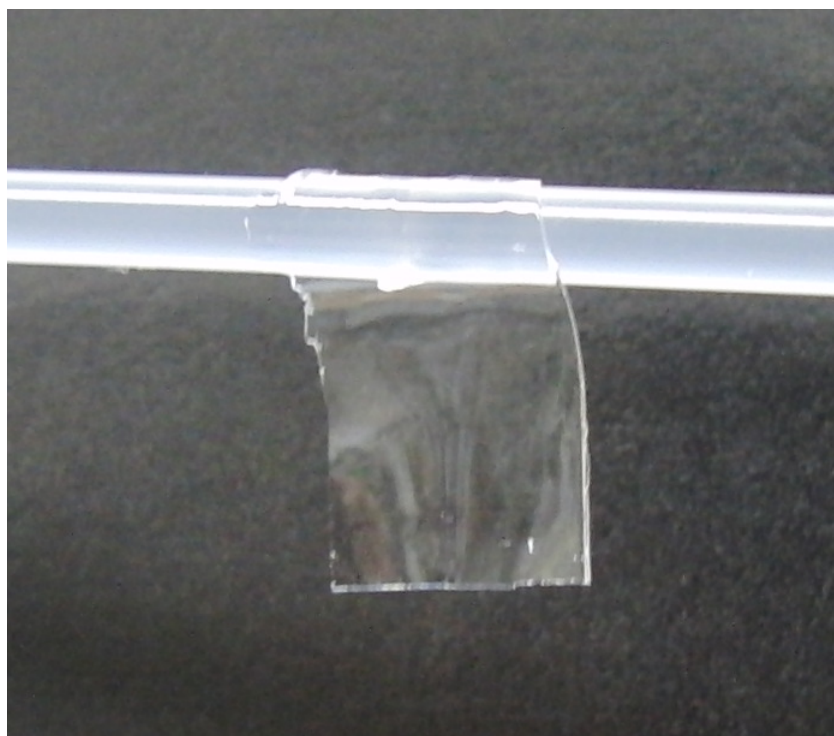
Fig. 4.13. [\text{C}_2\text{mIm}^+][\text{TFSA}^-] を溶媒として作製した Tetra-PEG イオンゲル薄膜
