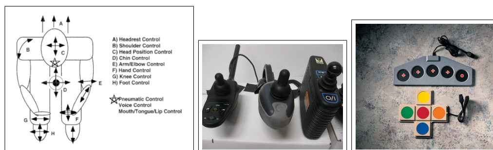
図 1.5: 電動車椅子向けの入力装置。左：操作に使える体の部分 [29]、中：ジョイスティック [32]、右：多数ボタン式の入力装置 [31]。
