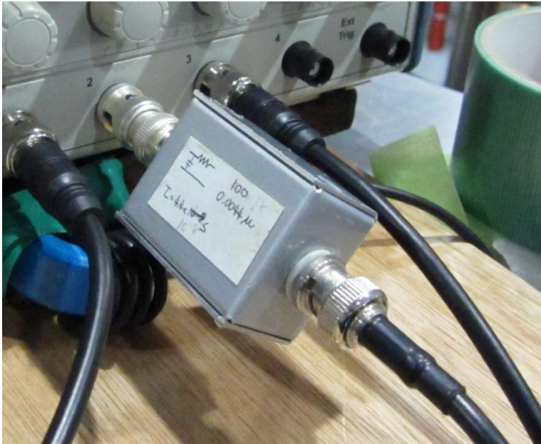
図 4.3.13 (a)浮遊・空間電位測定用のローパスフィルタ
