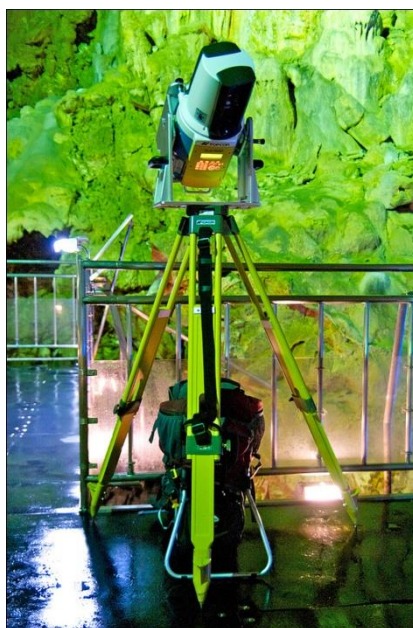
図 3.1. 3D レーザースキャナー GLS-1500.
