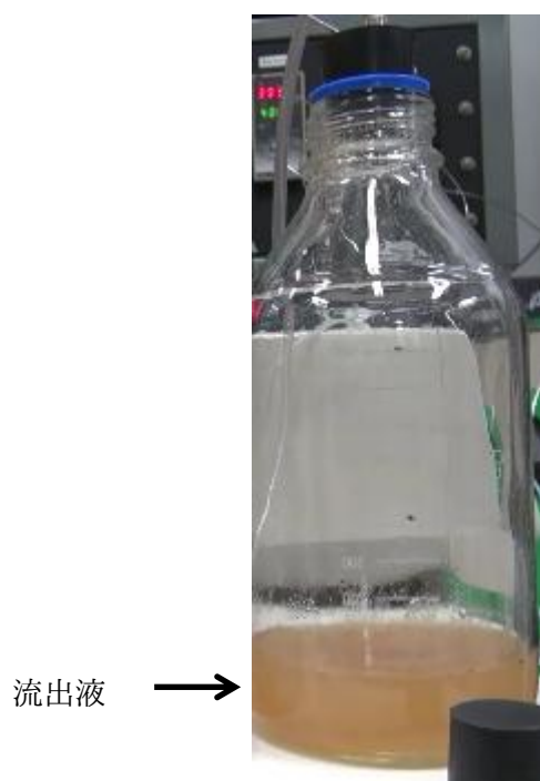
図 4.10 高濃度グリセリン流通時の流出液の写真 (400℃、33 MPa、グリセリン濃度：1.01 mol/L)
