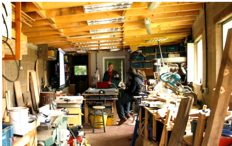
[写真] 内部の作業部屋。ラムドアースの壁が片流れの屋根を支えている。
