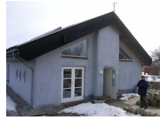
[写真] コモンハウスの一つ。 ストローベイル構法で建てられた。
