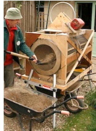
[写真] 自作の機械で土をふるいにかける
