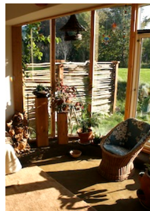
[写真] 温室の内部。床は石や漆喰であり、太陽熱を蓄える(サーマルマス)
