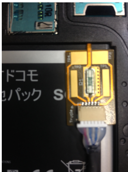
図 3 2 電流の測定方法
