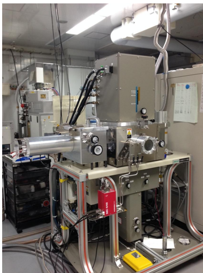
図 2.8 Ru を成膜するために用いたスパッタリング装置(E-200S、ANELVA)
