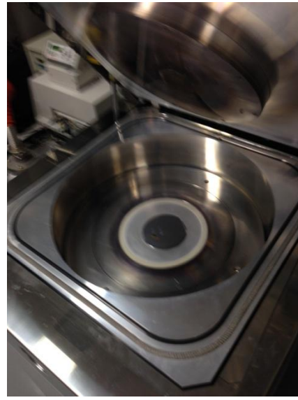
図 2.10 \text{RuO}_2 の成膜に使用した RIE (右：全体像 左：ターゲットを中に入れた様子)
