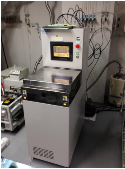
図 2.10 \text{RuO}_2 の成膜に使用した RIE (右：全体像 左：ターゲットを中に入れた様子)
