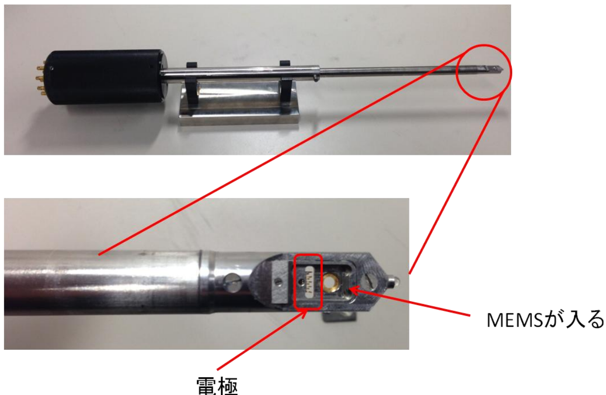
図 2.3 TME ホルダの全体写真(写真上)と TEM ホルダ先端部の拡大写真(写真下)
