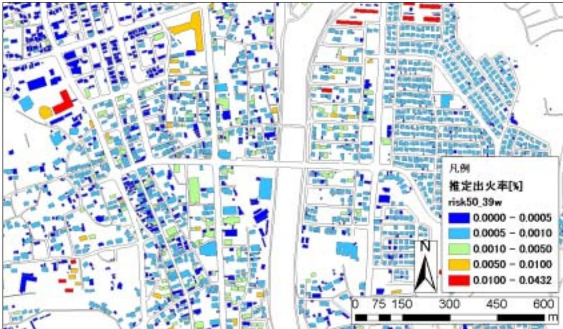
図 4.2.1 建物毎の出火率推定結果（50 年以内超過確率 39%の地震動入力を与えた場合・例）
