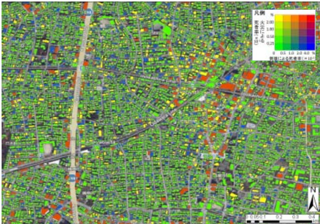
図 5.2.5 世田谷区北沢周辺における地震による倒壊・火災による死者率（50年超過確率 39%の地震が冬期夕刻に発生した場合）
