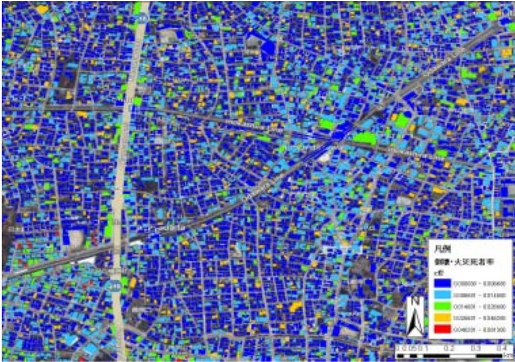
図 5.2.13 世田谷区北沢周辺における倒壊・火災リスクを複合して評価した死者率 (50年超過確率39%の地震が冬期夕刻に発生した場合)
