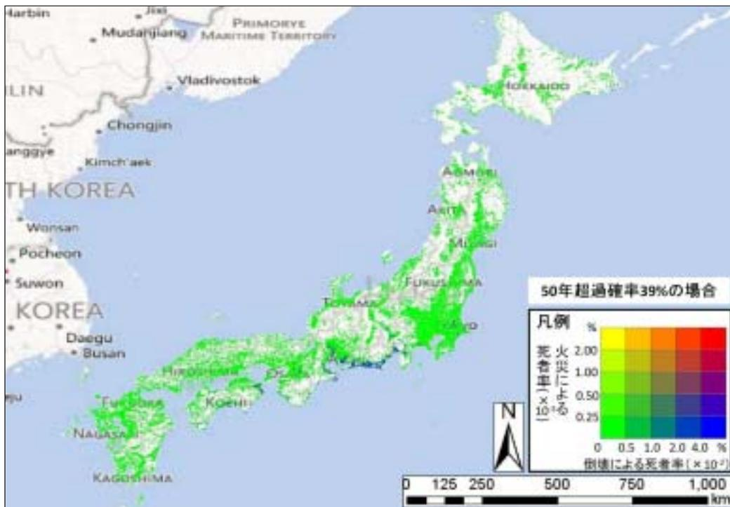
図 5.2.6 日本全土における地震による倒壊・火災による死者率（4次メッシュ集計・50年超過確率 39%の地震が冬期夕刻に発生した場合）
