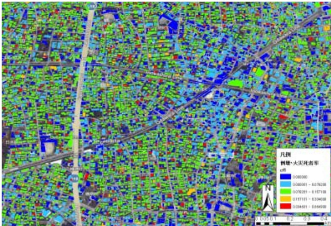
図 5.2.9 世田谷区北沢周辺における倒壊・火災リスクを複合して評価した死者率(50年超過確率 2%の地震が冬期夕刻に発生した場合)
