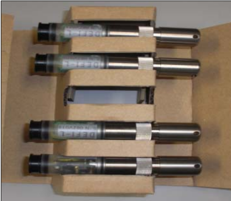
Fig. 3.5 Sensor used for PAR measurement.
